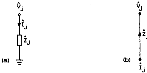
Şekil 4.8 : Basamaklı devrelerde girişe paralel olan kolların simüle devreye uyarlanmış sembolü ve işaret-akış diyagramı.
