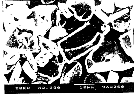
b) \text{Al}_2\text{O}_3 -%13 \text{TiO}_2 seramik toz morfolojileri: ilk fotoğraf düşük büyütme, ikinci fotoğraf yüksek büyütmedir.
