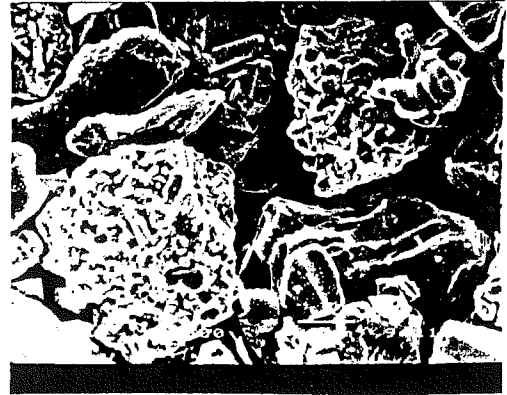
c) \text{Cr}_2\text{O}_3 -%5 \text{SiO}_2 -%3 \text{TiO}_2 seramik toz morfolojileri: ilk fotoğraf düşük büyütme, ikinci fotoğraf yüksek büyütmedir.
