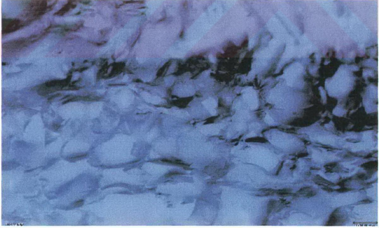
Şekil Ek 7.2 P = 350 Bar T = 70 °C t = 36 Saat Başlatıcı Konsantrasyonu = %15 (ağ/ağ) koşulları için SEM fotoğrafı
