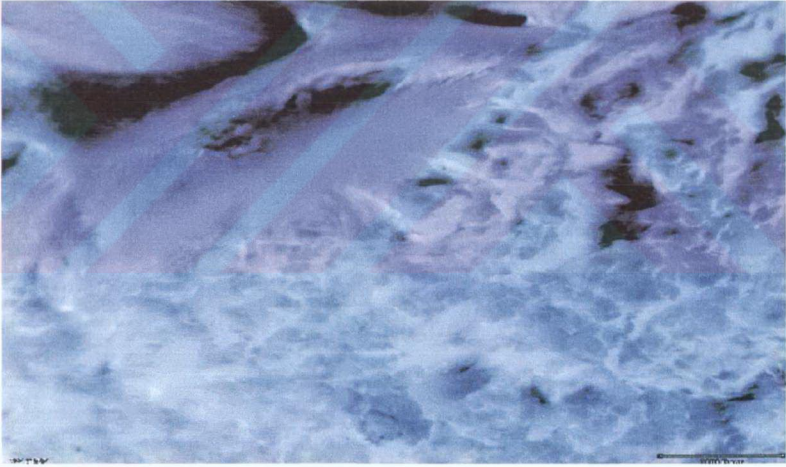
Şekil Ek 7.4 P = 300 Bar T = 60 °C t = 36 Saat Başlatıcı Konsantrasyonu = %5 (ağ/ağ) koşulları için SEM fotoğrafı
