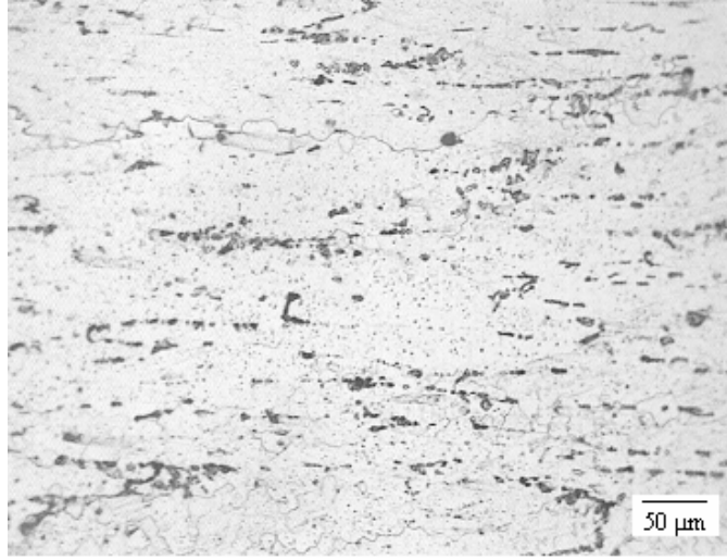
Şekil 5.29 T6 ısıt işlemleri durumundaki 5 numaralı numunenin ışık metal mikroskop görüntüsü
