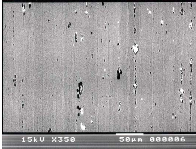
Şekil 5.23 220 °C' de 2 dakika retrogresyon ardından 130 °C' de yeniden yaşlandırılmış 2 numaralı numunenin taramalı elektron mikroskop görüntüsü
