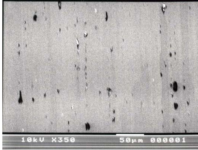
Şekil 5.19 180 °C’ de 10 dakika retrogresyon ardından 130 °C’ de yeniden yaşlandırılmış 2 numaralı numunenin taramalı elektron mikroskop görüntüsü
