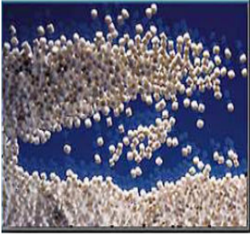
Şekil 3.2 Amorf yapıdaki PET
