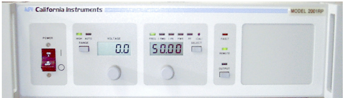
Şekil 3.3 Sinüsoidal güç kaynağının (California Instruments 2001 RP) ön panel görüntüsü
