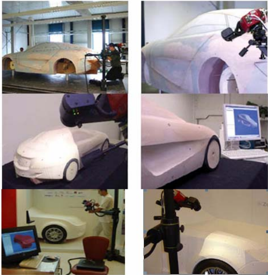
Şekil 2.37 Otomobil tasarımında kameralı tarama adımları [16]
