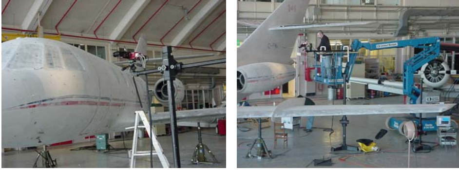
Şekil 2.39 Uçağın kameralı tarama sistemleriyle taranması [19]
