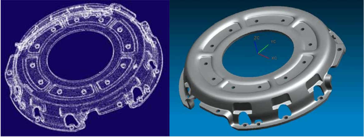
Şekil 2.46 Nokta bulutu olarak taranmış bir debriyaj kapağının 3D CAD modelinin oluşturulması [15]
