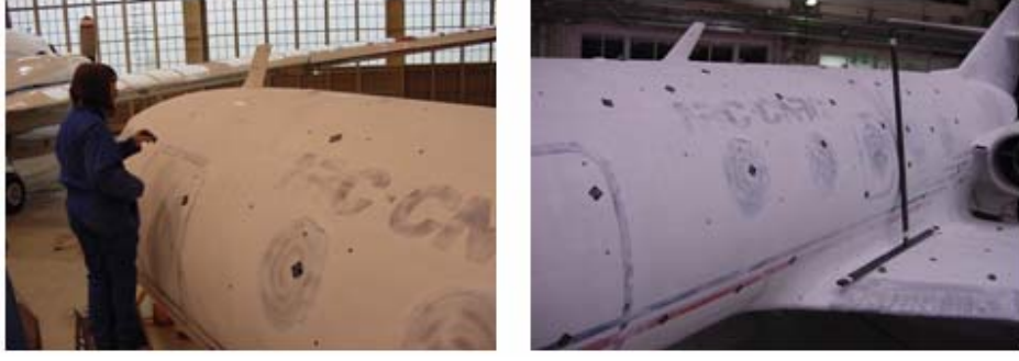
Şekil 2.38 Uçak tasarımında tarama yapılacak bölgelerin belirlenmesi [19]
