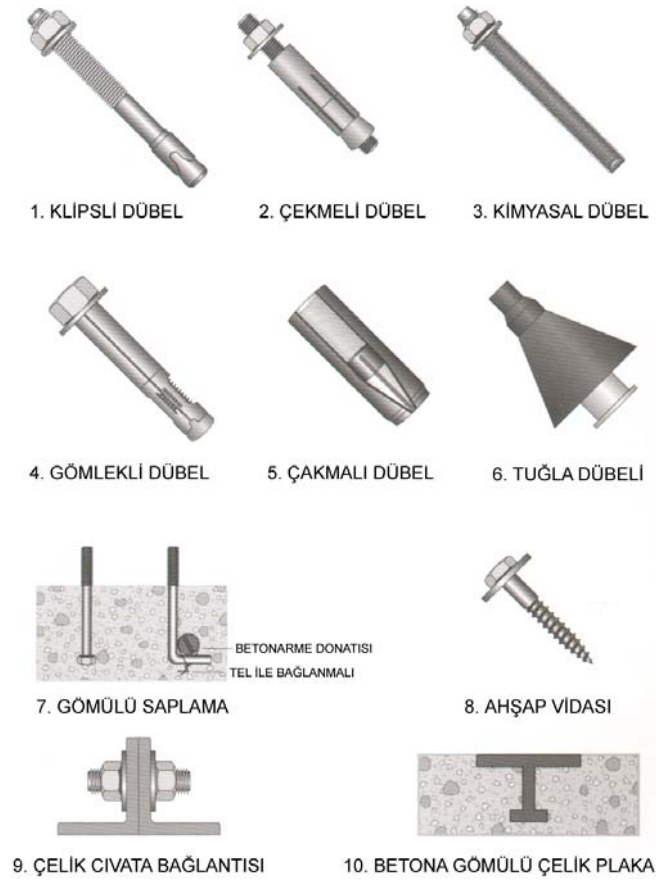
Şekil 3.64. Çeşitli bağlantı elemanları
