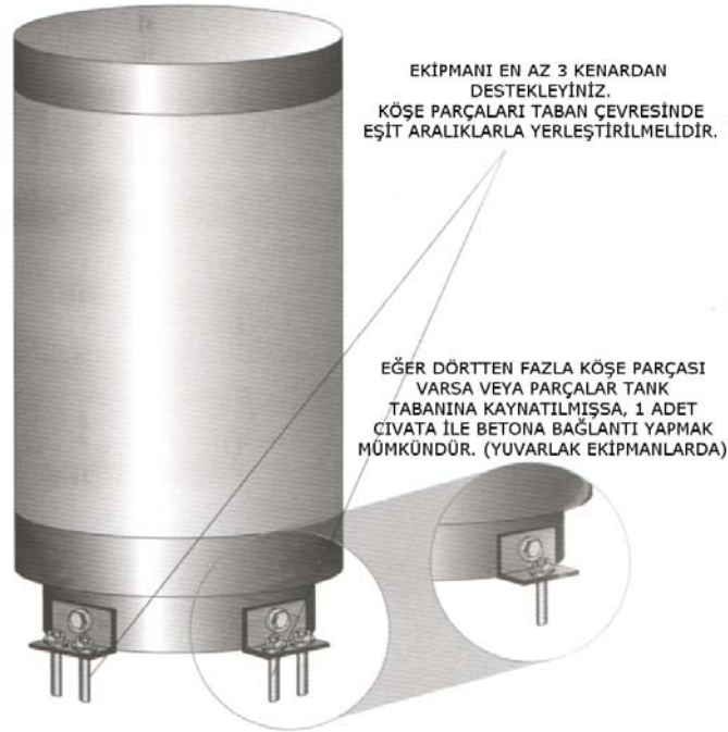
Şekil 3.8. Bir tankın döşemeye doğrudan bağlanması*
