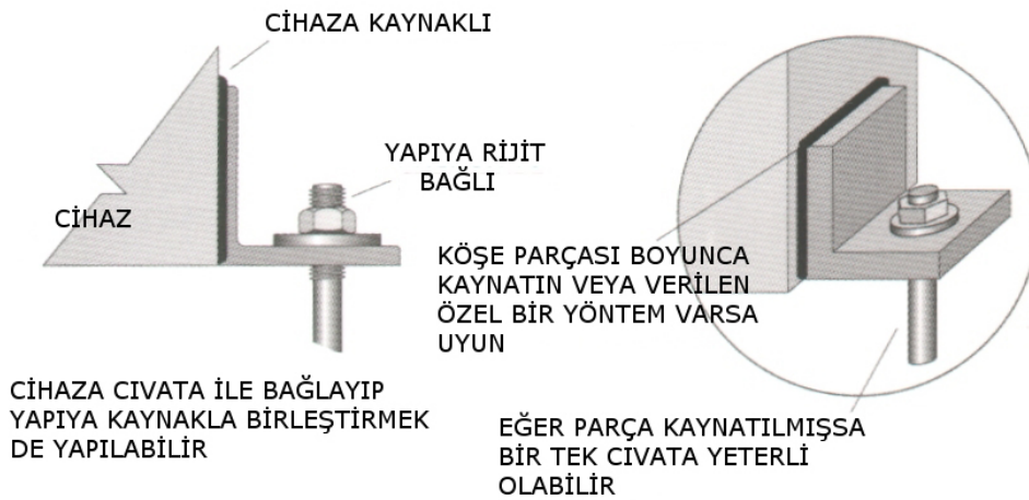
Şekil 3.6. Köşe takviye parçasının ekipmana kaynatılması*
