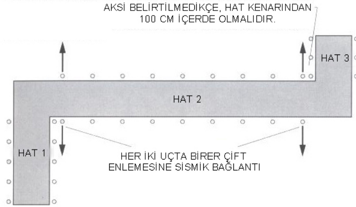
Şekil 3.24. Uçlarda birer çift enlemesine sismik bağlantı yerleşimi*
