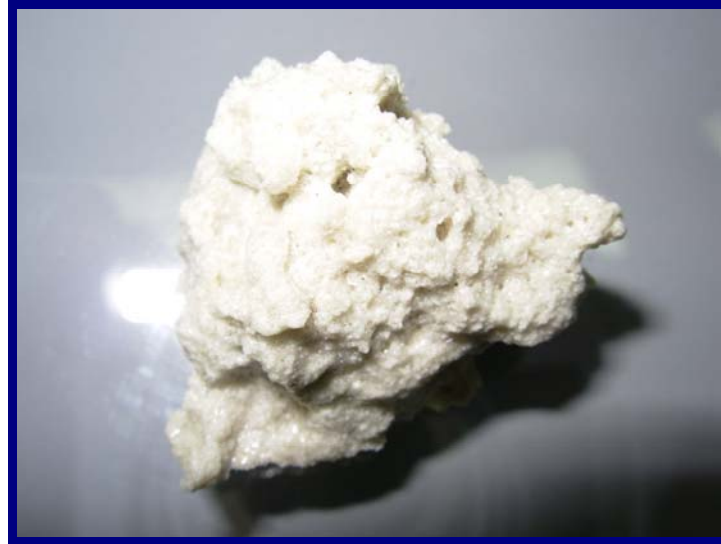
Çizelge 6. 25 III. Yüksek alüminalı (Supremax) camın soğuduktan sonraki görüntüsü (Oda sıcaklığında galvaniz saça dökülmüştür)
