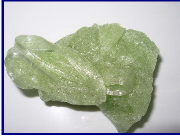
Şekil 6. 30 Galvaniz saça dökülen II. düz camın soğuduktan sonraki görüntüsü
