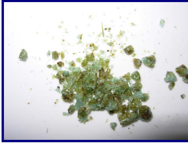
Şekil 6. 27 Üretilen I. düz camın soğuduktan sonraki görüntüsü (Su içine boşaltılarak şoklama yöntemiyle soğutulmuştur.)
