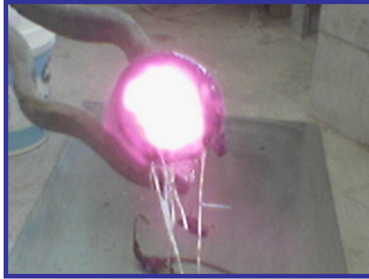
Şekil 6. 6 1350°C’de I. teknik (Pyrex) camın ergime sürecinin tamamlanış görüntüsü
