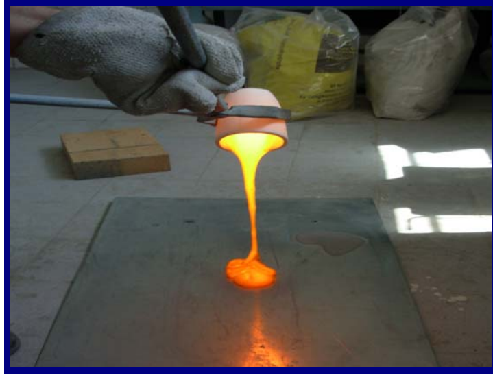
Şekil 6. 29 II. Düz cam numunesinin 1250°C 'deki galvaniz saça dökülüş görüntüsü
