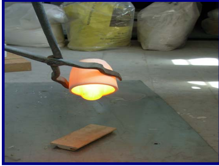
Şekil 6. 28 1215°C 'de II. düz cam numunesi
