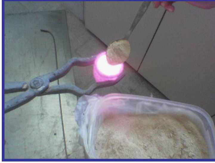
Şekil 6. 5 1081°C’de I. teknik (Pyrex) camın malzeme ilave ediliş görüntüsü
