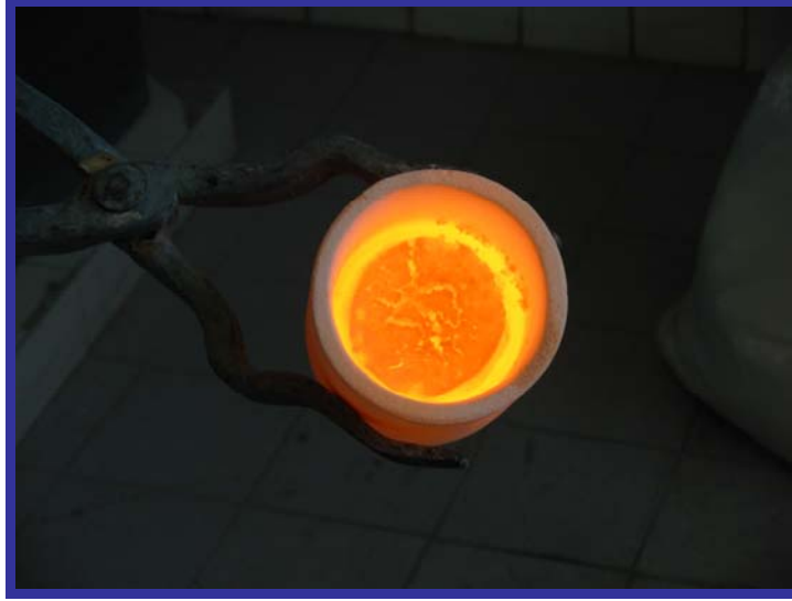
Şekil 6. 15 I.Yüksek alüminalı (Supremax) cam üretimindeki 1160 °C'de ki durumu
