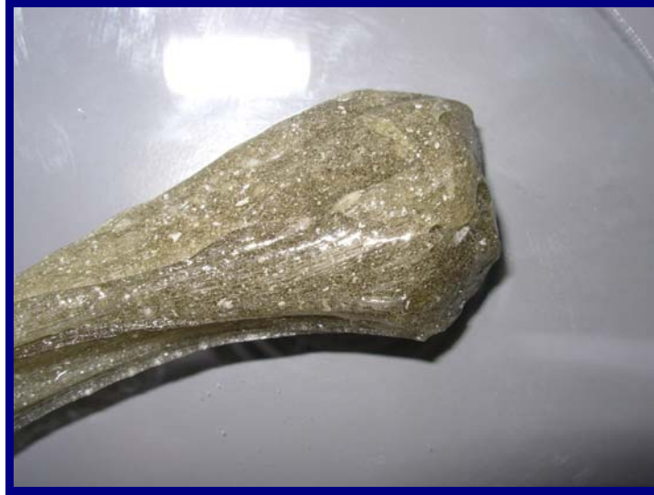
Şekil 6. 10 II. Teknik (Pyrex) cam numunesinin soğuduktan sonraki görüntüsü (Oda sıcaklığında galvaniz saça dökülmüştür)
