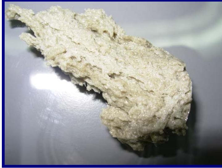
Şekil 6. 21 II. Yüksek alüminalı (Supremax) camın soğuduktan sonraki görüntüsü (Oda sıcaklığında galvaniz saça dökülmüştür)
