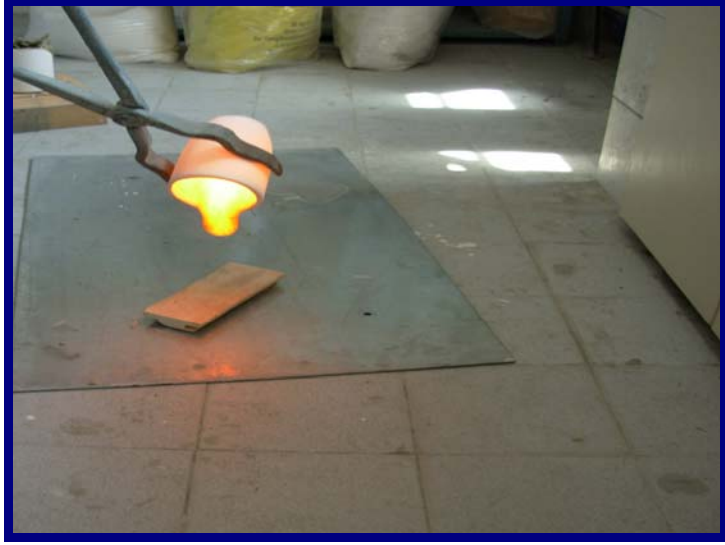
Şekil 6. 17 1300°C’de I. yüksek alüminalı (Supremax) camın ergime görüntüsü
