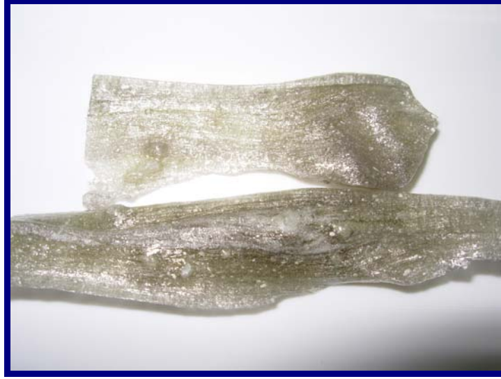
Şekil 6. 7 I.Teknik (Pyrex) camın soğuduktan sonraki görüntüsü (Oda sıcaklığında galvaniz saça dökülmüştür)
