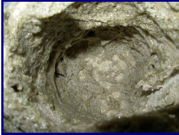
Şekil 6. 20 I. Yüksek alüminalı (Supremax) camın kontrollü soğuduktan sonraki görüntüsü
