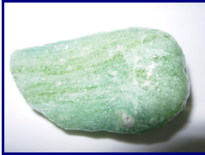
Şekil 6. 31 Galvaniz saça dökülen II. düz camın kontrollü soğuduktan sonraki görüntüsü
