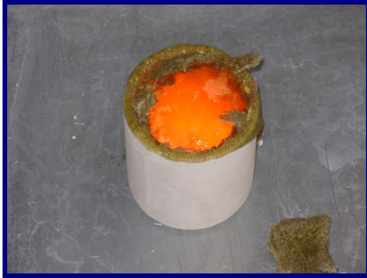
Şekil 6. 18 I. Yüksek alüminalı (Supremax) cam numunesinin soğuma görüntüsü
