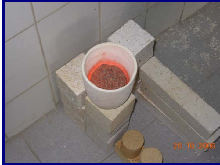
Şekil 6. 9 II. Teknik (Pyrex) cam üretiminde 740°C'deki yüzeydeki tabakalaşma görüntüsü
