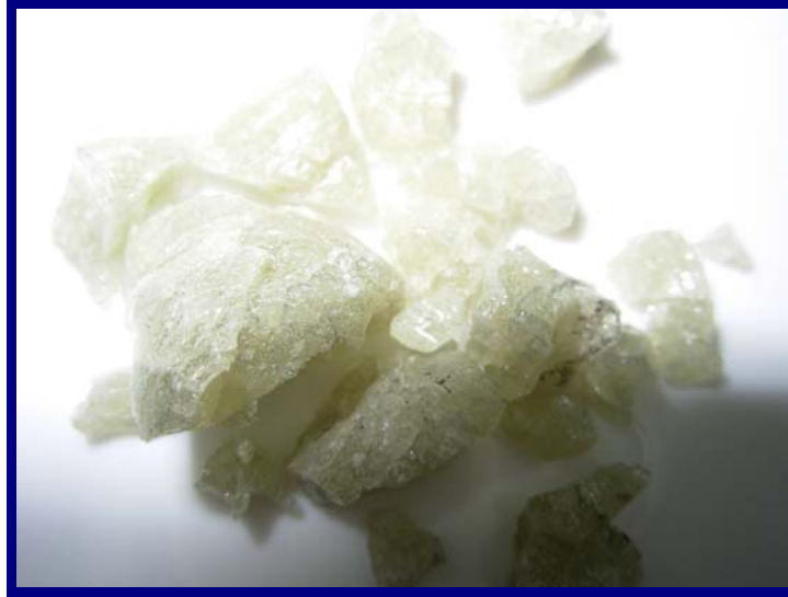
Şekil 6. 8 I.Teknik (Pyrex) camın soğuduktan sonraki görüntüsü (Su içine boşaltılarak şoklama yöntemiyle soğutulmuştur)
