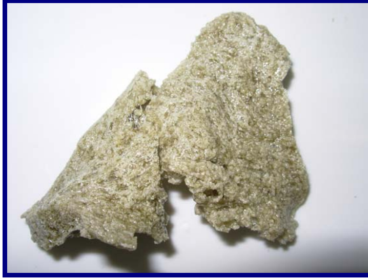
Şekil 6. 19 I. Yüksek alüminalı (Supremax) camın soğuduktan sonraki görüntüsü
