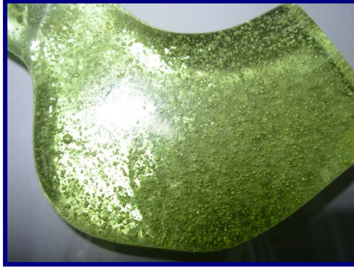
Şekil 6. 32 1250°C 'de III. düz cam üretiminde soğuduktan sonraki görüntüsü (Oda sıcaklığında galvaniz saça dökülmüştür.)
