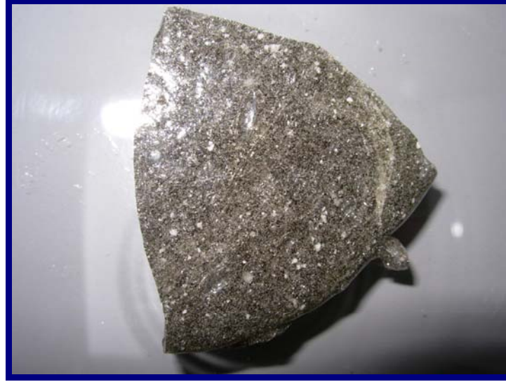
Şekil 6. 11 III. Teknik (Pyrex) camın soğuduktan sonraki görüntüsü (Oda sıcaklığında galvaniz saça dökülmüştür)
