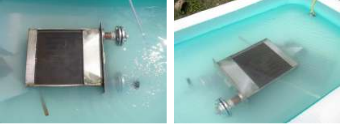
Resim 6.17 ve Resim 6.18 Basınç Testi Sırasında Isı Deęiřtiricisi
