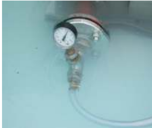
Resim 6.19 Basınç Testi Sırasında Isı Deęiřtiricisine Takılan Manometrenin Durumu
