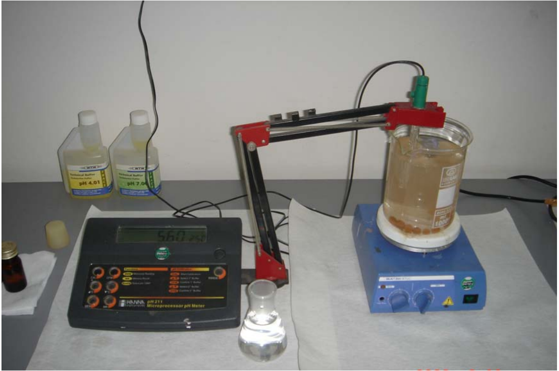
Şekil 7.5 Adsorpsiyon deneyinin yapılışı
