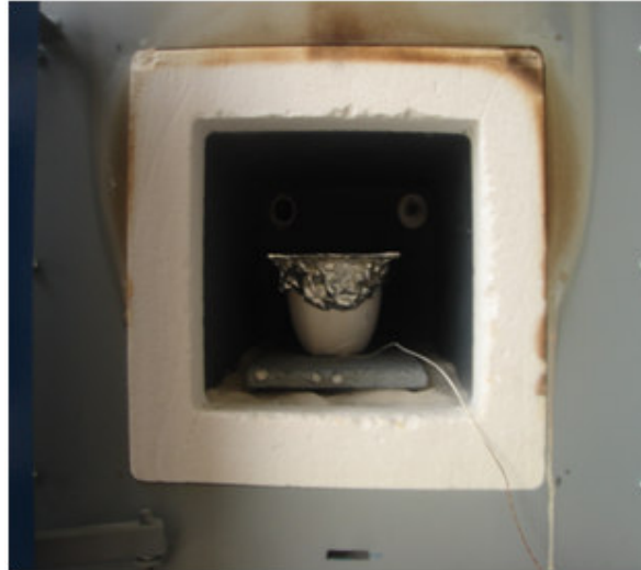
Şekil 6.3 Metal kutu metodunda kaplama ile fırına koyulan emayenin şematik görünümü.
