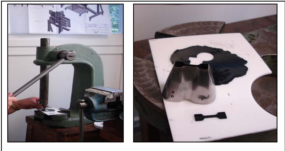
Şekil 5.12 Köpek kemiği (dogbone) mekanik test için örnek kesimi ve bir örnek
