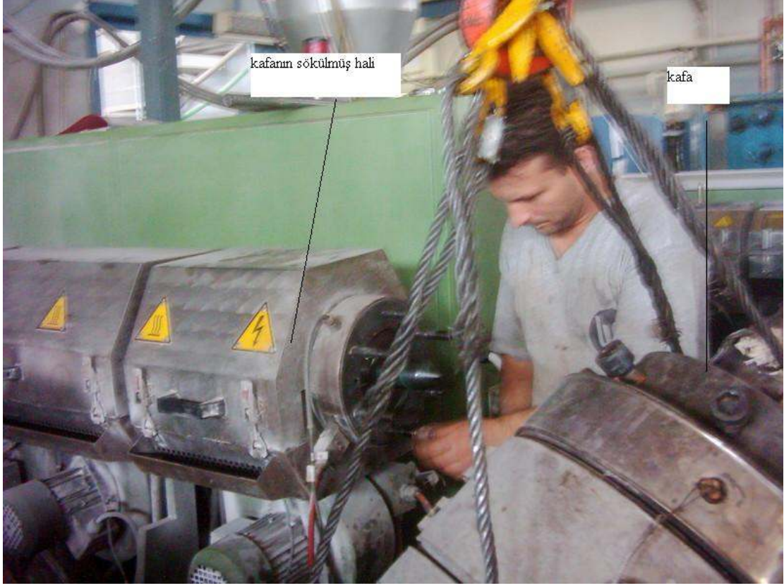
Şekil 8.5 Ekstrüder kafasının sökülmüş hali
