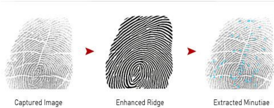
Şekil 2.7 Parmak izi tanımda görüntünün işlenmesi
