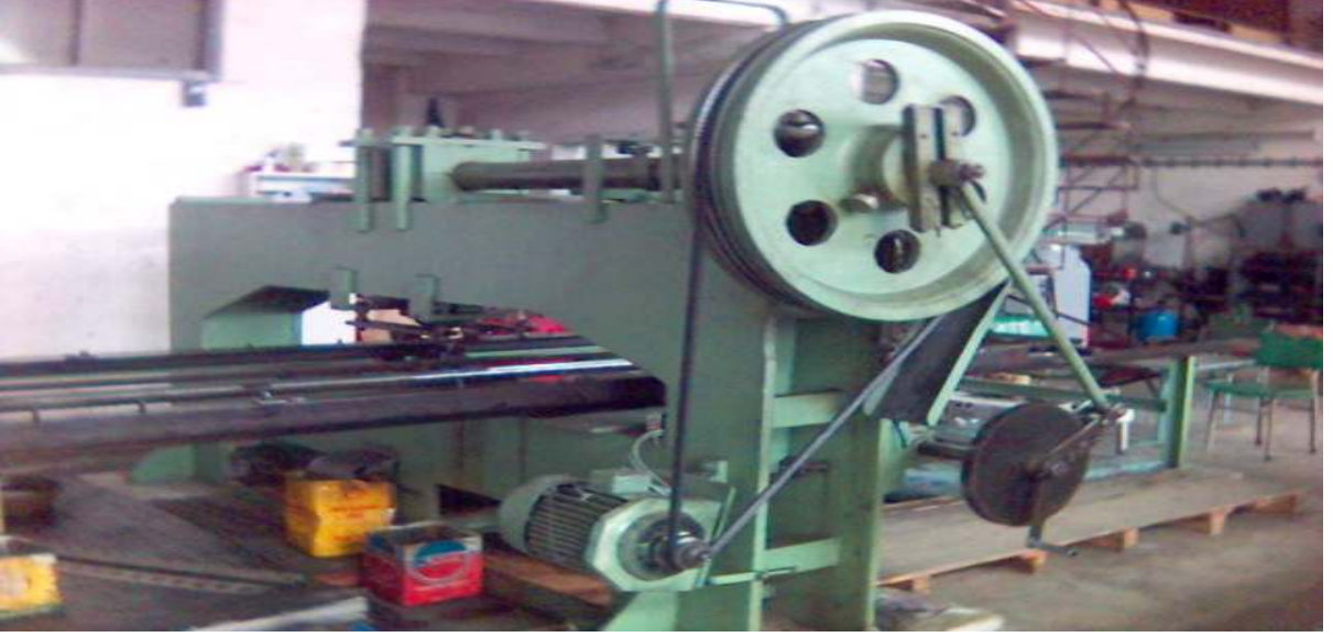
Resim 2. Pres makinesinde volanın görünümü
