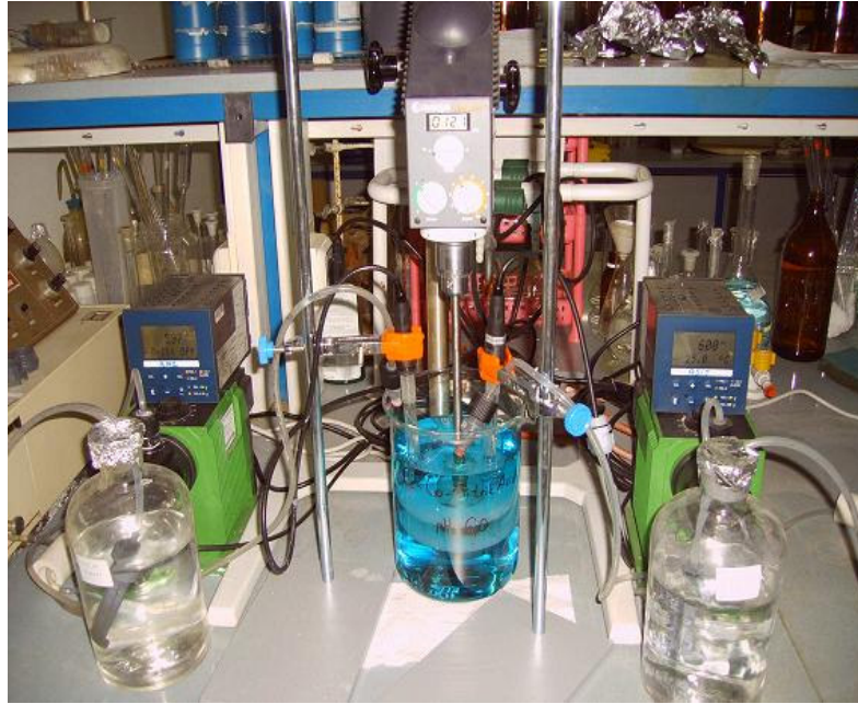
Şekil 3.3 pH'ya baęlı Parametrik Pumping yöntemiyle sulu çözeltilerden metal iyonu karışımının ayrılmasına yönelik dizayn edilen sistem
