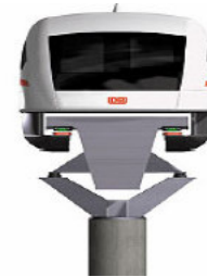
Şekil 3.5 Alttan asılı (Suspended) ve üstten giden (Straddle) tekraylı sistemler
