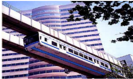
Şekil 3.5 Alttan asılı (Suspended) ve üstten giden (Straddle) tekraylı sistemler
