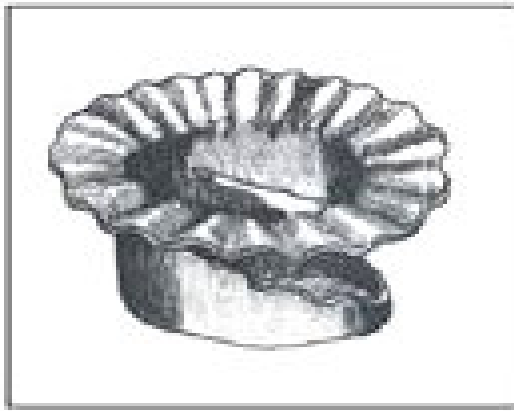
a) Malzemenin kıvrılması hali
