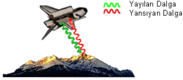
Şekil 4.6 Bir tek alıcı ile gönderilen ve yansıyan radar dalgaları (Maathuis, 2004).
