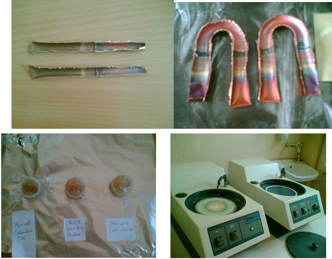
Şekil 6.16 İç yapı incelemesi öncesinde numunelerin hazırlanması
