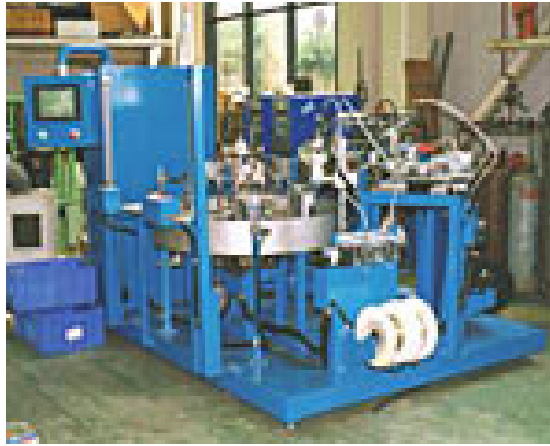
Şekil 5.10 Seri imalat için uygun 4-12 istasyonlu döner tablalı bir otomatik lehimleme makinesi (Daishin Ind.)
