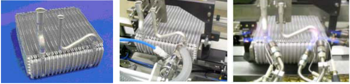
Şekil 5.14 Soldan sağa 1) Bitmiş evaporatör 2) Lehim bölgelerine lehim pastası uygulanması 3) Otomatik lehimleme işlemi (Fusion Inc.)
