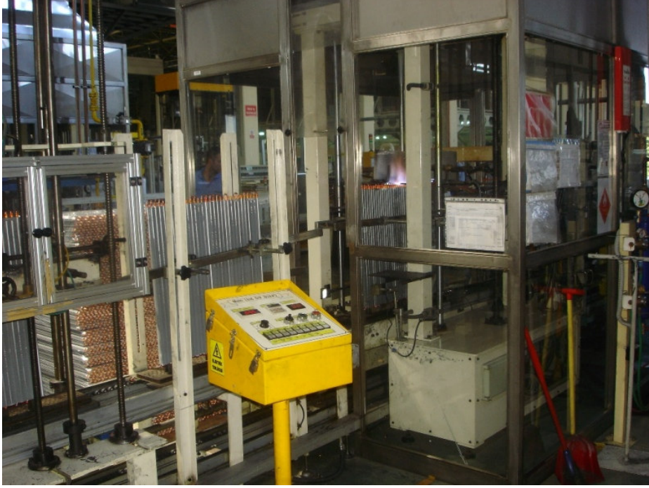
Şekil 6.2 Isı deęiřtiricilerin lehimlenmek üzere konveyör ve palet üzerinde otomatik lehimleme istasyonuna taşınması
