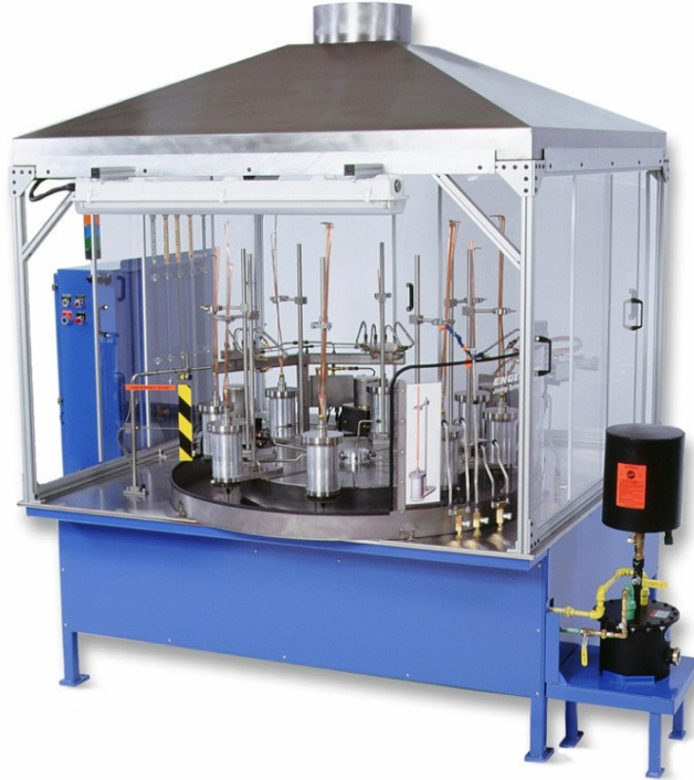
Şekil 5.8 Distribütör yapımında kullanılan bir döner lehimleme istasyonu
