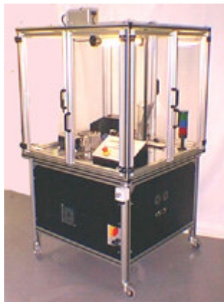
Şekil 5.24 CBN, PCBN, PCD ve karbür takım uçlarının lehimlenmesinde kullanılan bir sistem. Bir seferde 40 – 60 uç birden lehimleme kapasitesiyle günde 500 uça kadar işlem yapılabilmesine olanak sağlamaktadır (BrazeSolutions Inc.)
