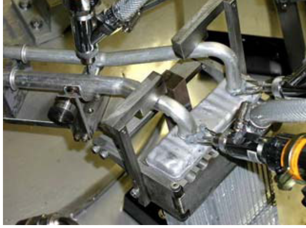
Şekil 5.5 3 adet tabanca ile önceden belirlenmiş miktarda lehim pastası birleşme bölgelerine verilmekte. (Fusion Inc.)
