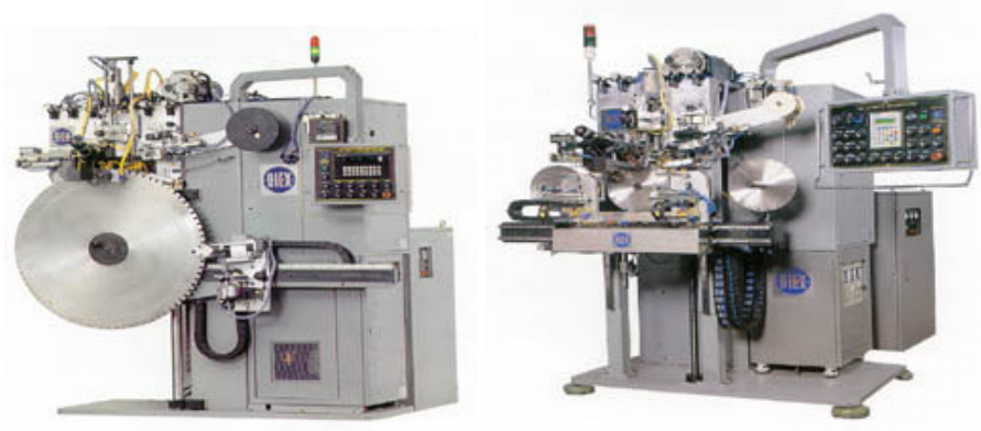
Şekil 5.11 Solda; tam otomatik PLC kontrollü bir daire testere diş-uç lehimleme makinesi. Uç besleme; birleşme bölgesine taşıma; lehimleme; dekapan miktarı ayarlama ve soğutma işlemleri tam otomasyonlu olarak uygulanmaktadır. 400-2000 mm. çaplı daire testere için kullanılabilir. Sağda; bu tezgahın 150-400 mm. arasındaki küçük çaplı daire testere için kullanılan bir türdeşi görülmektedir. (Diex Corp.)
