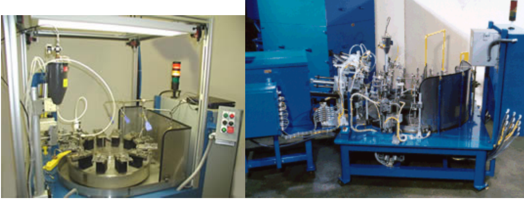
Şekil 5.3 Solda yarı otomasyonlu (operatör tarafından malzeme beslemesi yapılan); sağda ise tam otomasyonlu lehimleme istasyonları (Fusion Inc.)
