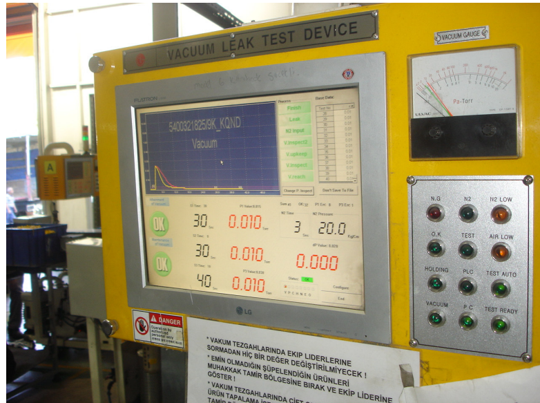
Şekil 6.26 Kaçak test cihazı (üstte) ve kontrol paneli (altta)
