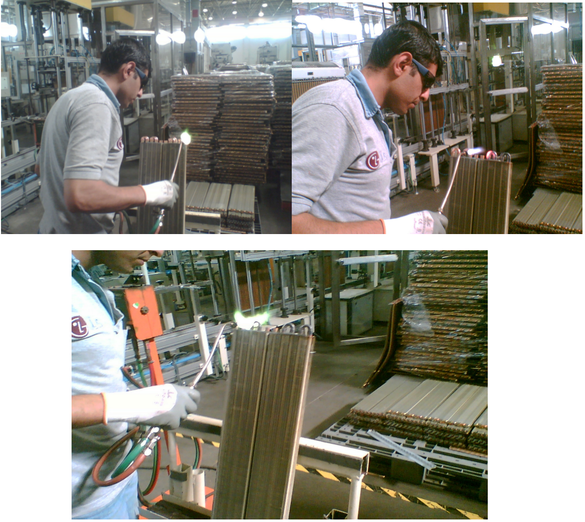
Şekil 6.5 Elle lehimleme işleminin operatör tarafından gerçekleştirilmesi
