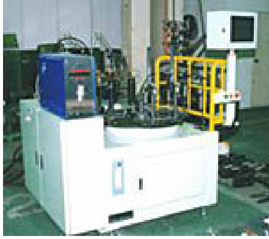
Şekil 5.25 180° dönebilen bir tablaya sahip 2 hücreli otomatik lehimleme makinesi. Bir parça lehimlenirken diğer bir parça makineye bağlanabilir (Daishin Ind.)
