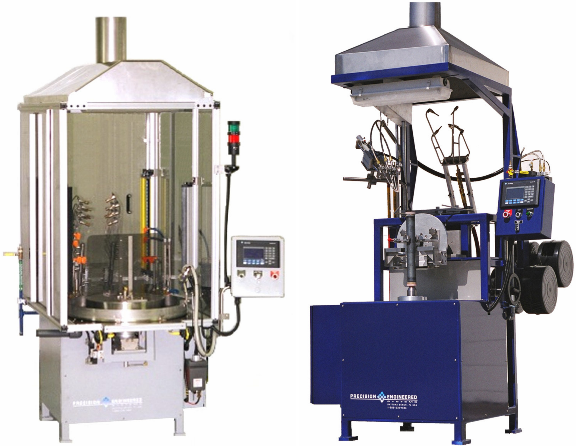
Şekil 5.26 Solda; bir parça lehimlenirken diğerinin operatör tarafından makineye yüklenmesine olanak veren döner tablalı bir lehimleme makinesi görülmektedir. (Fusion Inc.) Sağda ise; aynı parçanın alt ve üstündeki iki ucunu da lehimlemek için kullanılan düşey döner hücreli bir lehimleme makinesi görülmektedir. (Precision Engineered Systems, LLC.)
