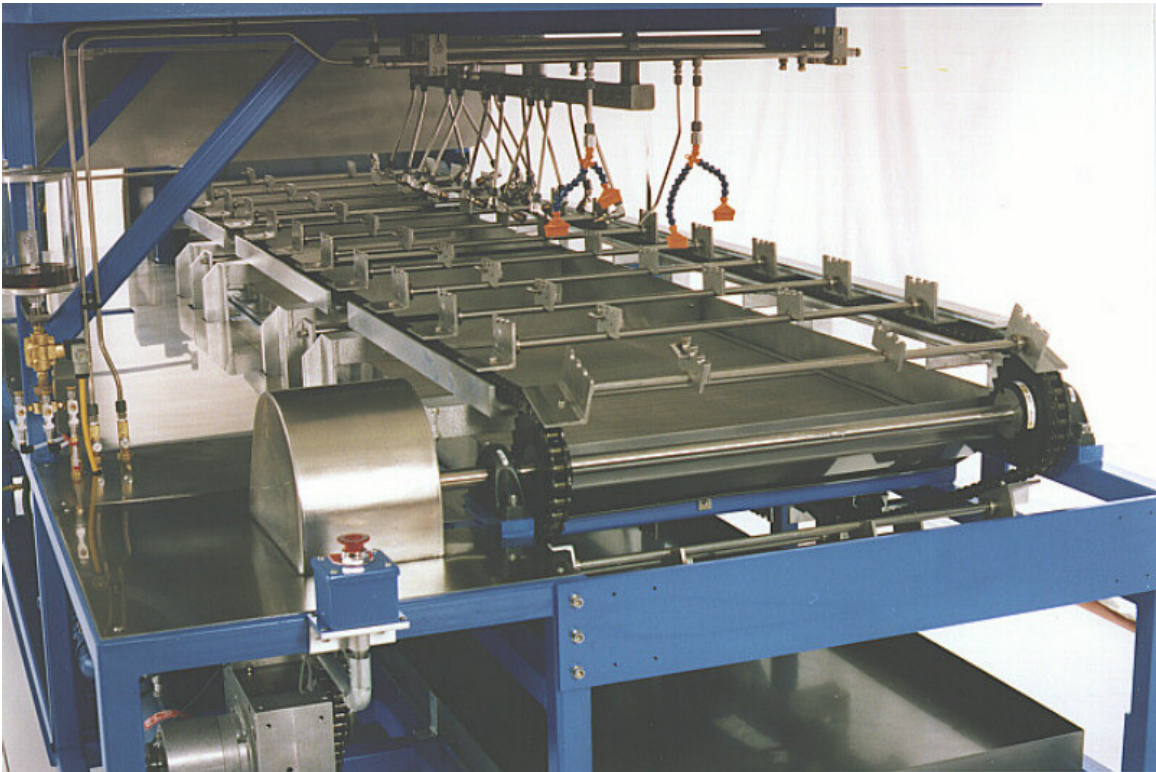
Şekil 5.16 Lehimlenecek parçaların bir konveyör ile transport edildiği doğrusal lehimleme istasyonları (Precision Engineered Systems, LLC.)
