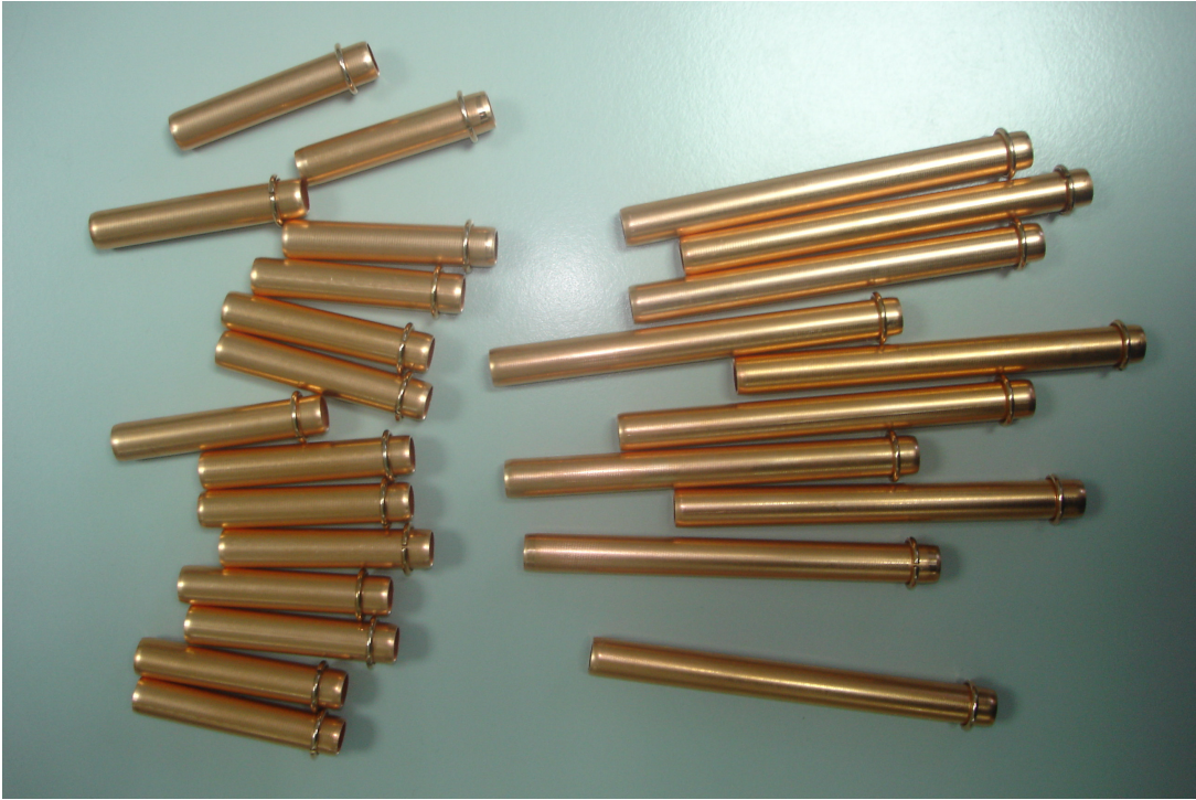
Şekil 6.13 Numune olarak kullanılmak üzere lehimlenmek için hazırlanmış düz bakır borular ve halka lehim tellerinin bu borulara bağlanması
