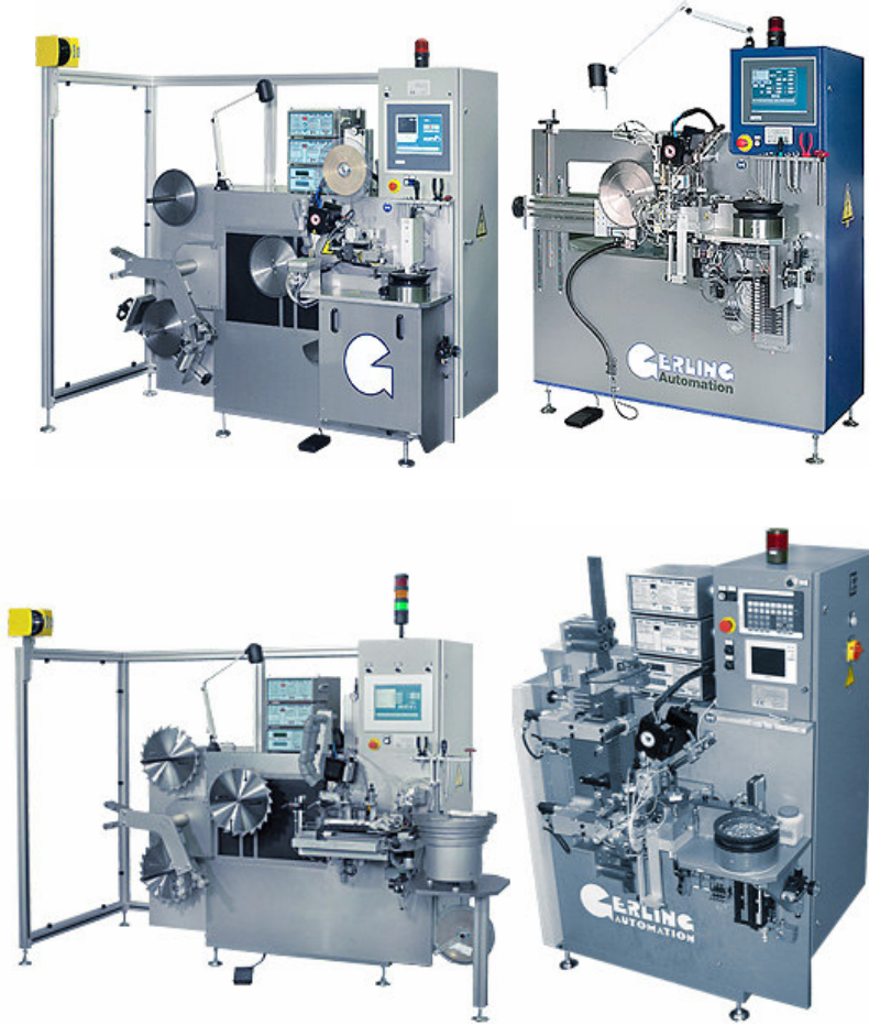
Şekil 5.12 Daire testere dişlerini (1., 2. ve 3. fotoğraf) ve şerit testere dişlerini (4. fotoğraf) ana gövdeye lehimlemek için kullanılan otomatik lehimleme makineleri. Bu makineler dekapan miktarı ayarlama; uçları lehimleme bölgesine taşıma; otomatik soğutma gibi özelliklerinin yanında lehim teli şekli ve boyutlarını istenilen değerlerde otomatik olarak kesme, lehimleme sıcaklıklarını - lehimleme sonrası tavlama sıcaklıklarını otomatik olarak ayarlamaya imkan verme gibi özelliklere de sahiptir. (Gerling Automation)
