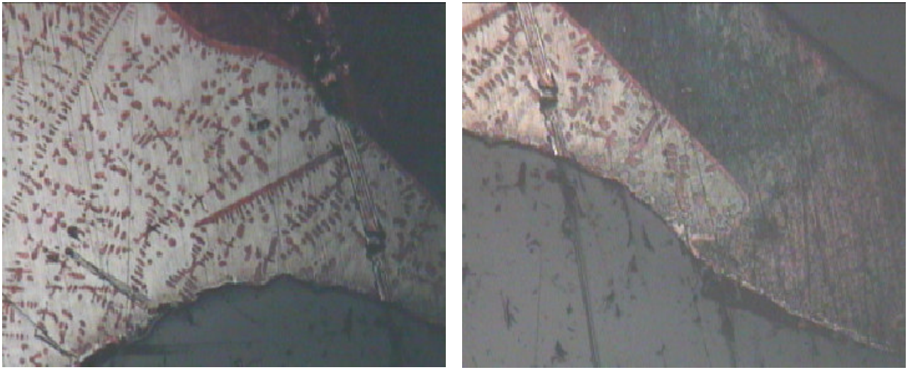
Şekil 6.21 Otomatik lehimleme istasyonunda lehimlenmiş bakır boruların 100X büyütme ile alınmış iç yapı fotoğrafları. 1. fotoğraf lehim başlangıcı; 2. ve 3. fotoğraf lehim gövdesi; 4. fotoğraf lehim sonunu göstermektedir.
