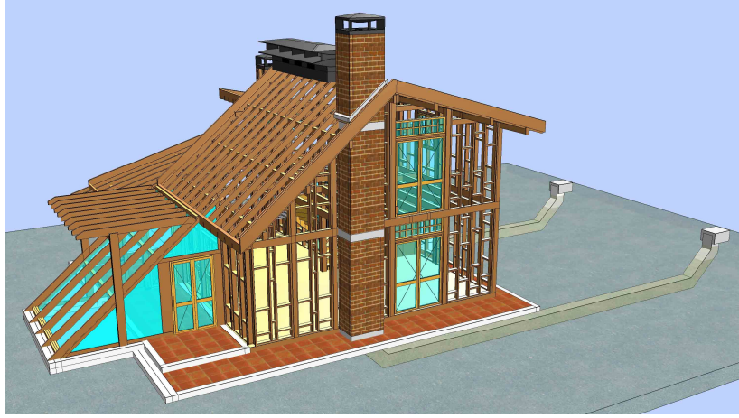
Şekil 5.61 Kuzey yönünde toprak altında döşenen boruların görünümü (Erengözgin, 2008)
