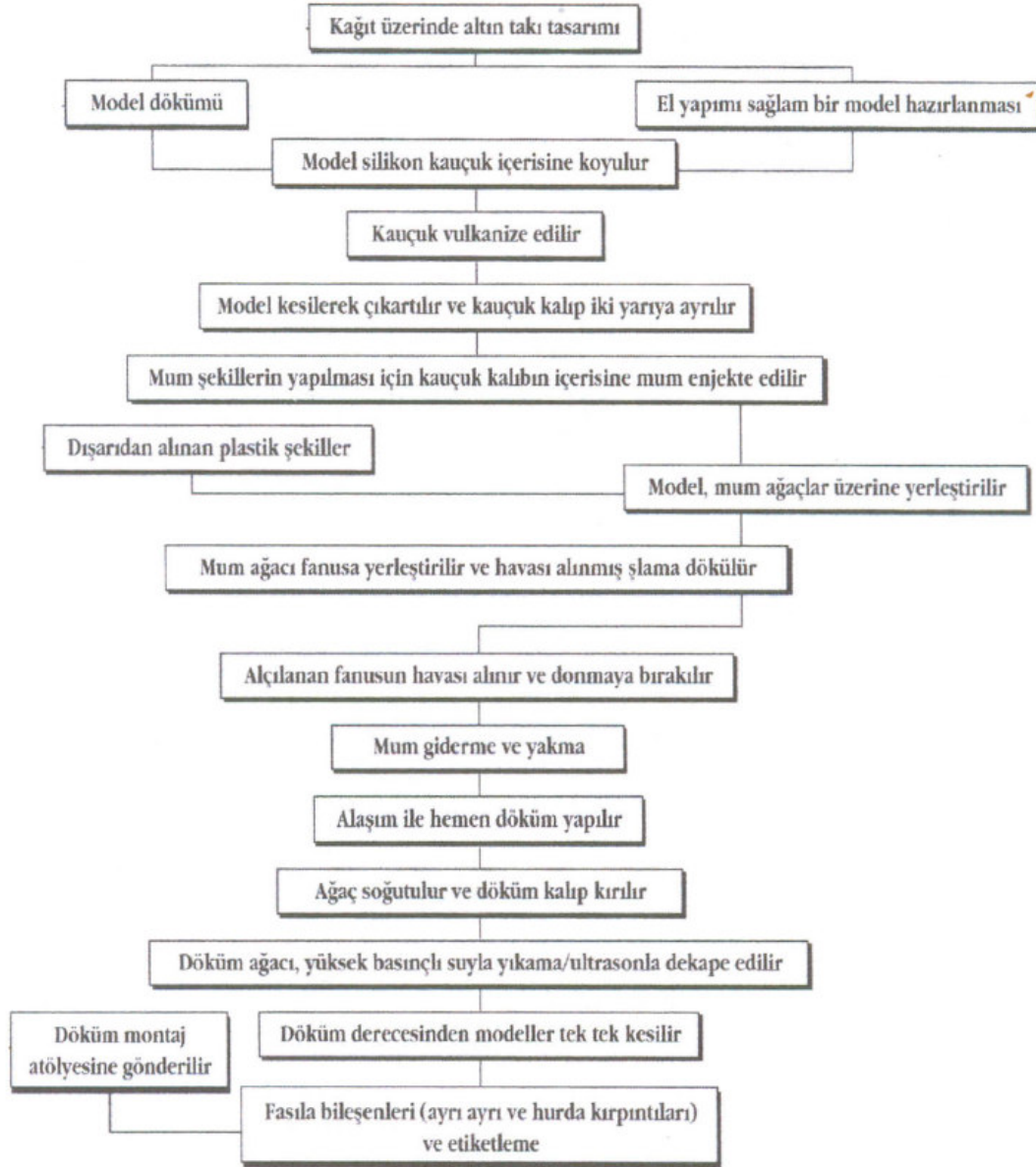
Şekil 4.2 Kuyumculukta dereceli hassas döküm işlem kademeleri (Wright, 1998).
