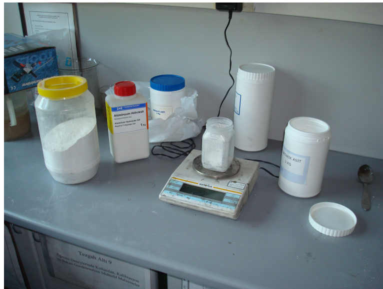
Şekil 8.1 Toz karışımının hassas terazide tartılarak hazırlanması
