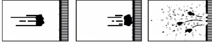
Şekil 3.5 Aşındırıcı raspa sisteminin çalışma prensibi
