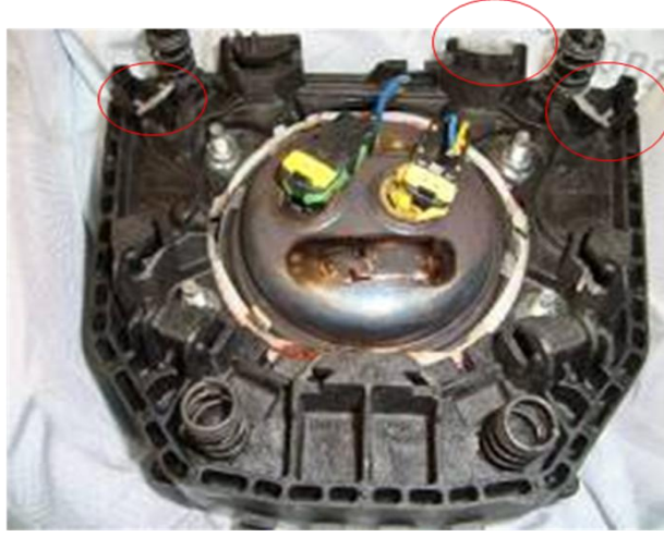
Şekil 5.16 Konteynır üzerinde kırılan arka ayaklar
