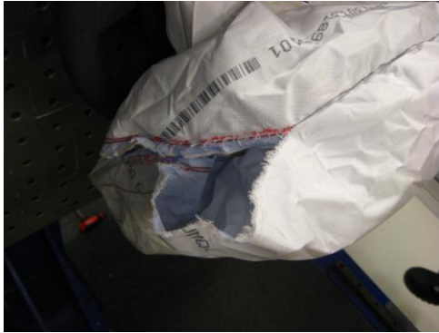
Şekil 5.17 +80°C’ de yapılan yatay darbe testi ve patlatma testi sonrasında yastık yırtılma problemi
