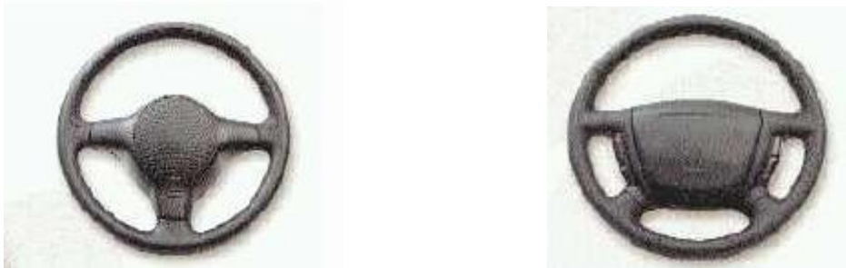
Şekil 4.3 Farklı tasarıma sahip sürücü hava yastıklarının direksiyona monte edilmiş görünümü
