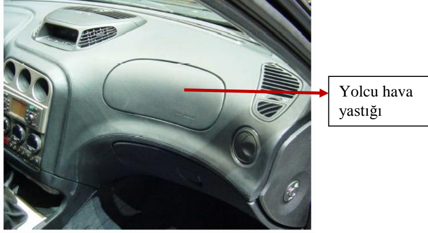
Şekil 4.5 Görünür şekilde monte edilmiş yolcu hava yastığı
