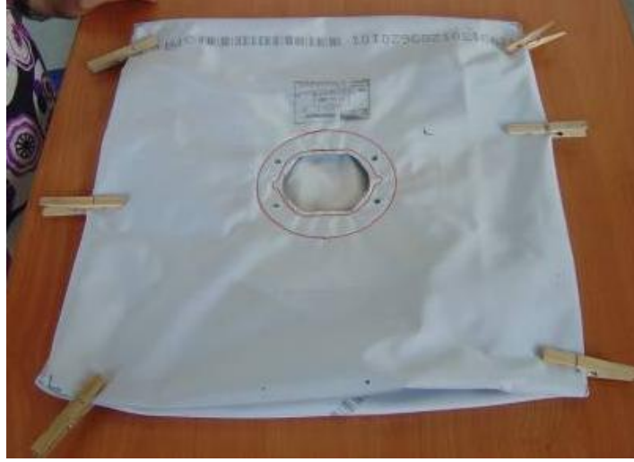
Şekil 5.22 Diyagonal katlama için geliştirilen yastık formu
