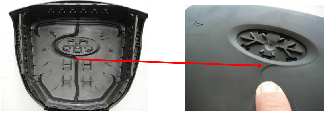
Şekil 4.16 Patlama anında yırtılma çizgisinde ilk açılacak nokta
