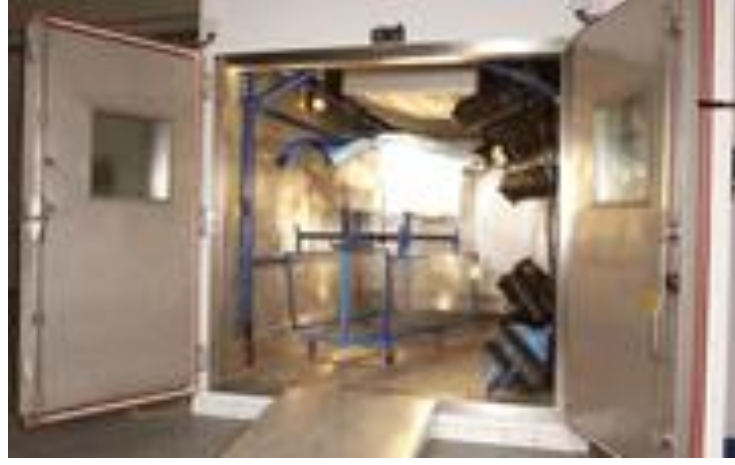
Şekil 5.6 Şartlandırmalarda kullanılan klimatik oda
