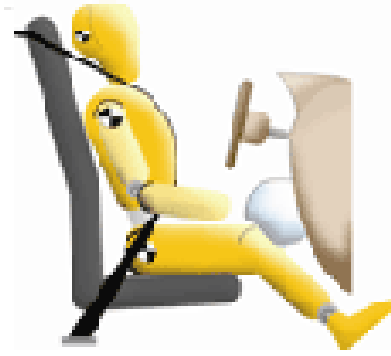
Şekil 3.2 Diz hava yastığının araç içerisindeki konumunun şematik olarak gösterimi
