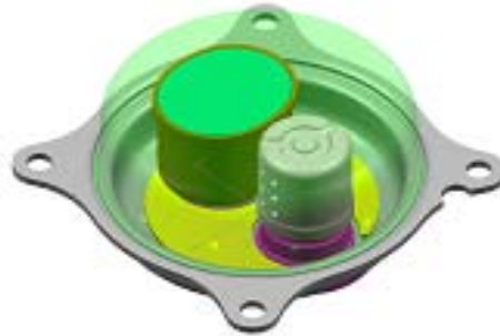
Şekil 4.35 Tek kademeli yıldız flanşlı inflatör
