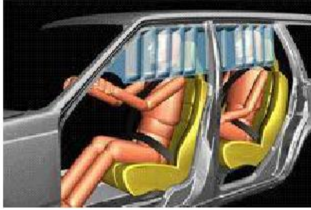
Şekil 4.10 Perde hava yastığının araç içinde patlamış halinin şematik olarak gösterilişi
