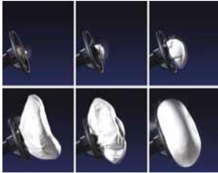
Şekil 4.4 Sürücü hava yastığının açılma anından maksimum hacme ulaşmasına kadar 0, 6, 12, 18, 24 ve 30 ms' lerdeki görünüşleri (Newgard vd., 2005)
