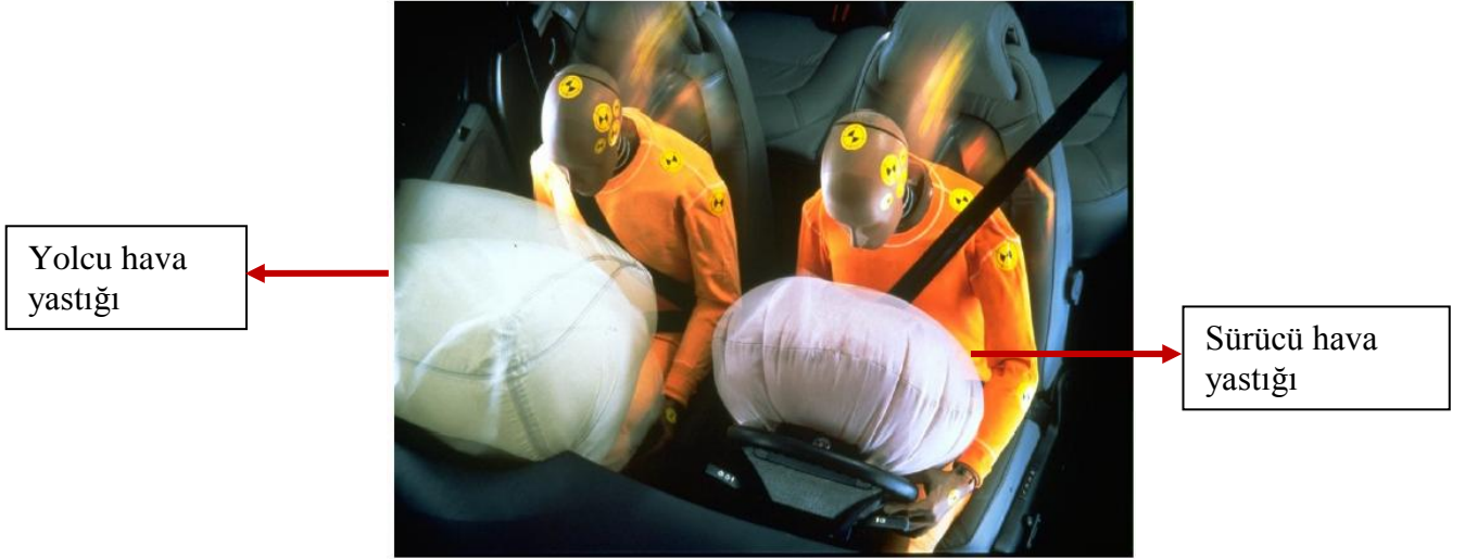
Şekil 4.2 Ön hava yastıklarının araç içerisinde açılmış görünüşü
