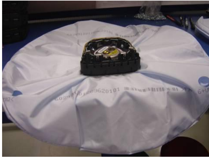
Şekil 5.21 Konteynır- yastık-jeneratör ön montajı
