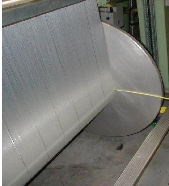
Şekil 4.29 İpliklerin sarılma işlemi
