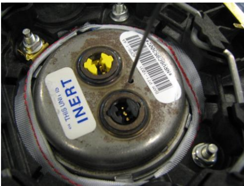
Şekil 5.7 Sıcaklık ölçümü için hazırlanan sürücü hava yastığı
