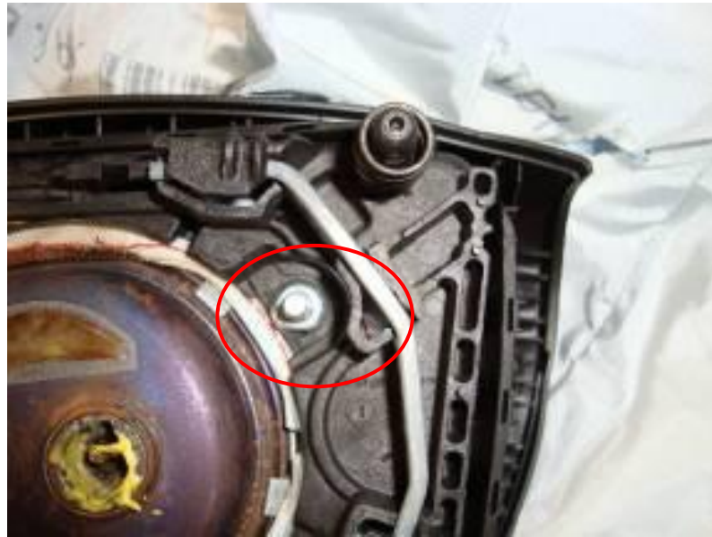
Şekil 5.12 Patlatma testi sonrasında kırılan arka ayaklar
