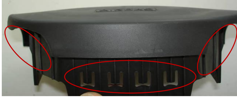
Şekil 4.17 Kapak klipsleme bölgeleri
