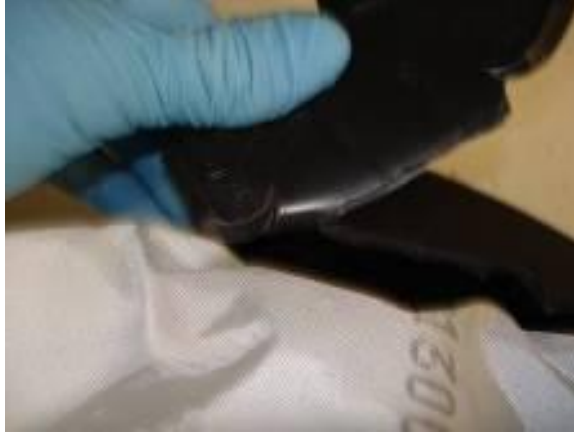
Şekil 5.11 Kapakta yırtılma çizgisinin yanlış yerden açılmaya devam ettiği durum
