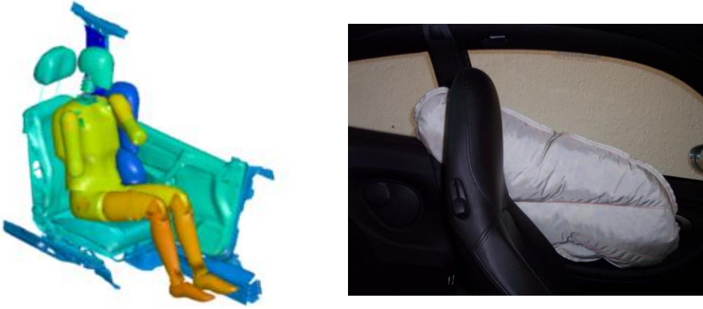
Şekil 4.9 Göğüs-kalça koruması için geliştirilen yan hava yastığının görünüşü
