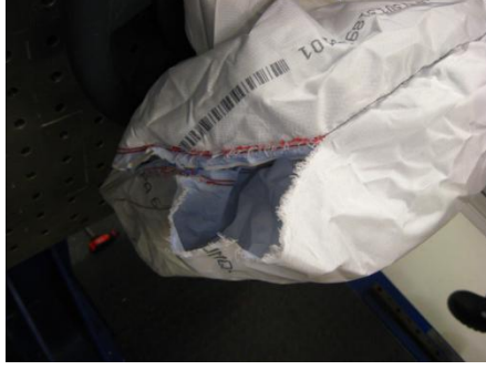
Şekil 5.14 Yatay darbe testi çevre dikişleri kopan yastık
