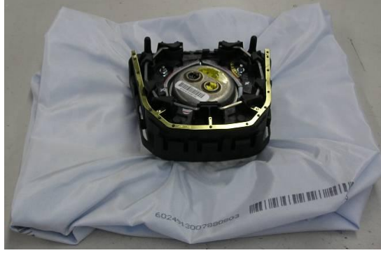
Şekil 4.24 Konteynır-yastık ön montajı
