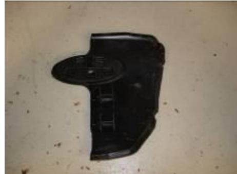
Şekil 5.15 Testler sonucu kapaktan kopan parçalar
