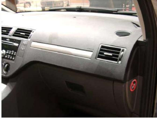
Şekil 4.6 Görünmez şekilde monte edilmiş yolcu hava yastığı
