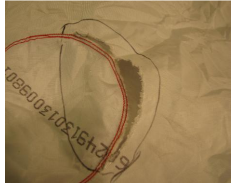
Şekil 5.17 +80°C’ de yapılan yatay darbe testi ve patlatma testi sonrasında yastık yırtılma problemi
