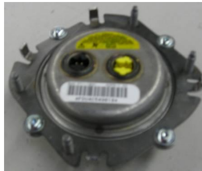
Şekil 4.37 Yıldız geometrili flanş
