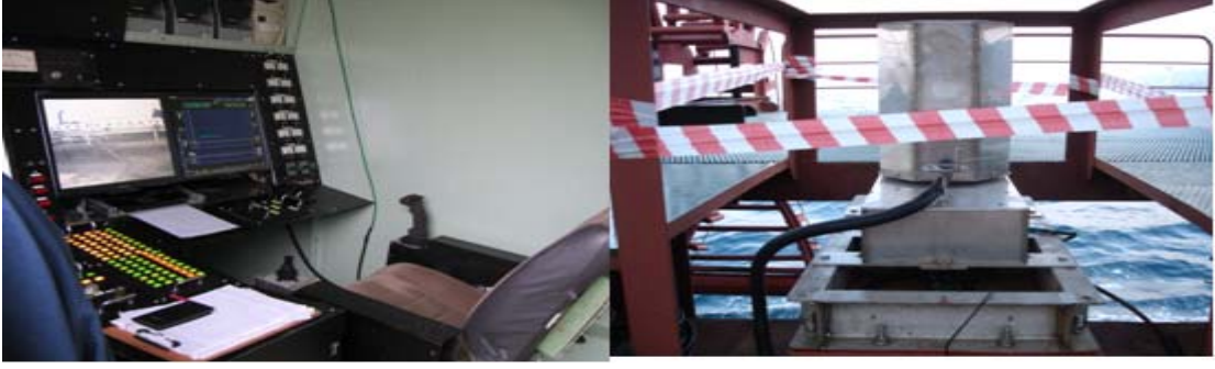
Şekil 6.29 Armarin 3 Gemisi'nde bilgilerin toplandığı kontrol odası ve transponder sistemi
