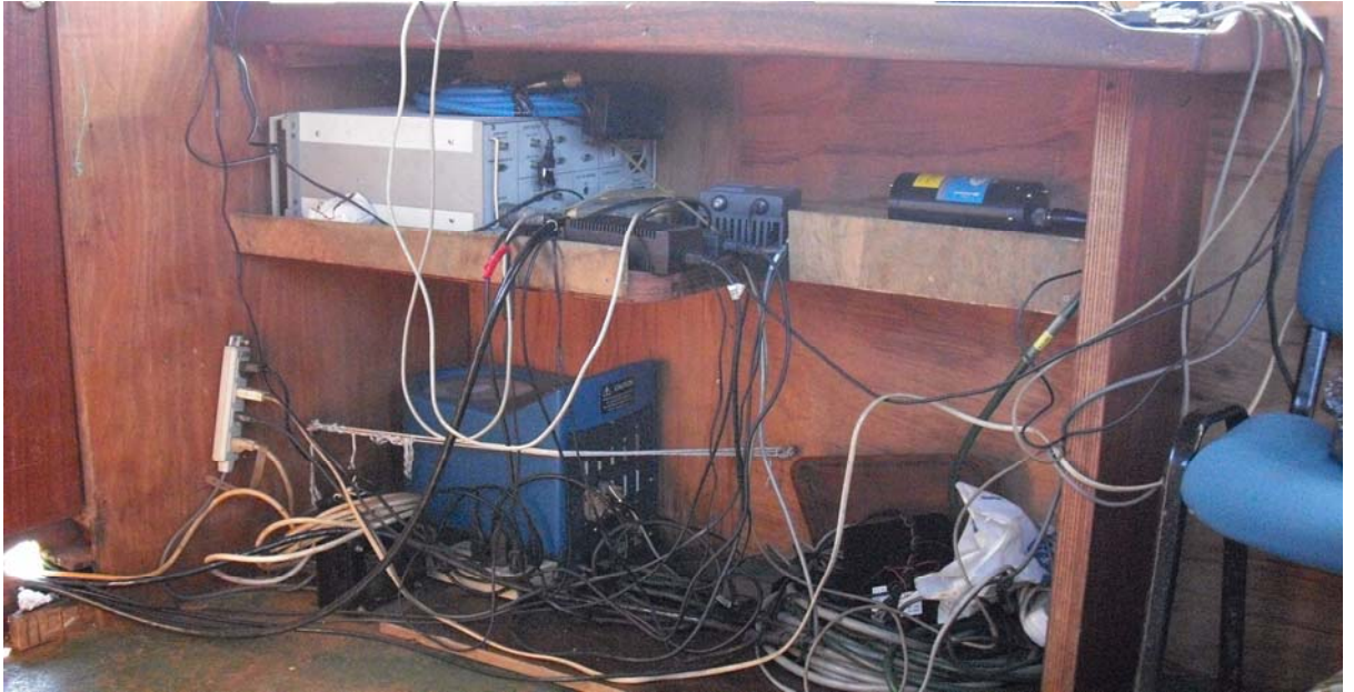
Şekil 6.68 Armarin-10 Teknesi içine kurulan gyro pusula, RTK-GPS ve hareket sensörü
