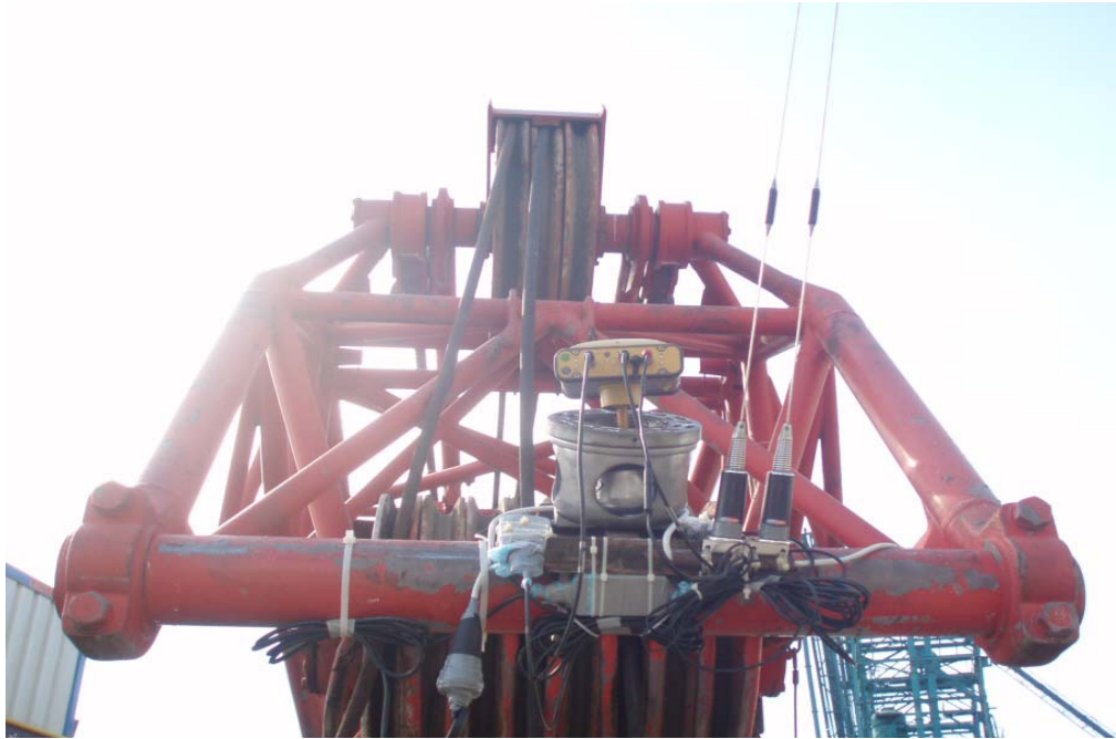
Sekil 5.13 Hiper GGD alıcı, Antennex modem anteni, GPS holder ve Satel harici modem
