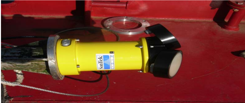
Şekil 6.40 ADP 'nin boruya bağlanması
