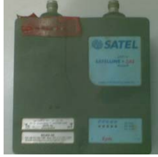
Şekil 6.5 Baz istasyonunda kullanılan harici modem
