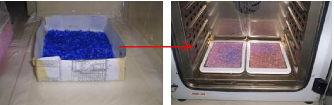
Şekil 4.5: Nem tutucuların kuru halden doymuş hale dönüşümü
