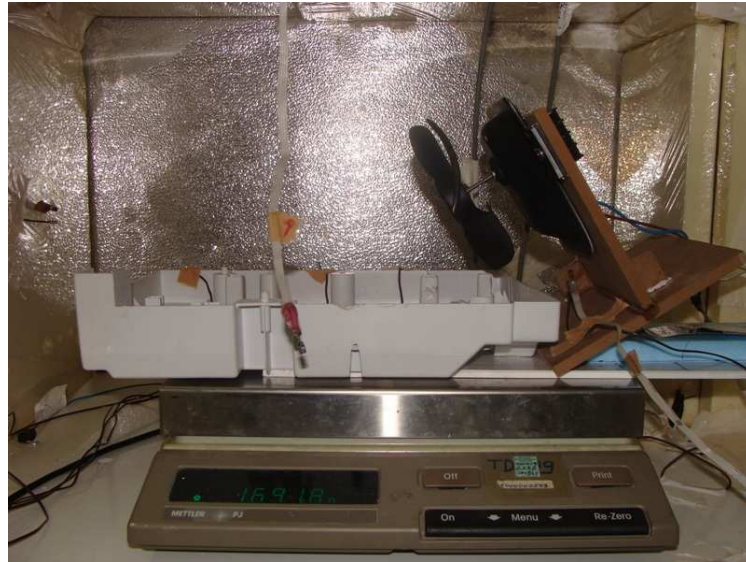
Şekil 5.14: Aksel fanın açılı olarak yerleştirildiği deney düzeneği
