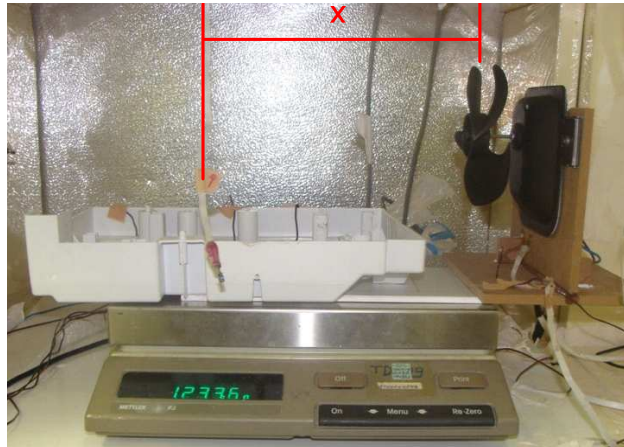
Şekil 5.13: Fan eksen mesafesi çalışmaları için oluşturulan düzenek
