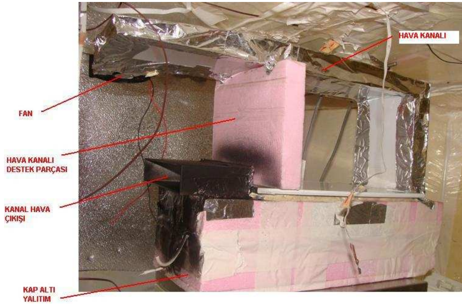
Şekil 4.15: Zorlanmış taşınım deneyleri için oluşturulan deney düzeneği
