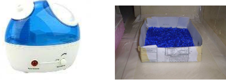
Şekil 4.4: Nemlendirici ünite ve nem tutucu malzeme
