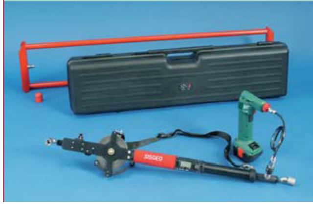
Şekil 3.7 Konverjans ölçümü için kullanılan şerit ekstansometre
