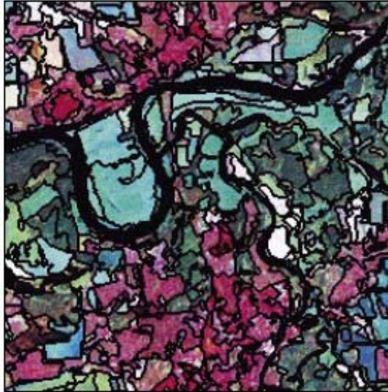
Şekil 4.10 Düşük heterojenlik sonucu geometrik anlamda bozuk şekillerin oluşması (Baatz vd., 2005)
