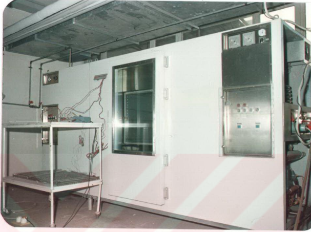
Şekil 6. Dondurulma işlemlerinin yapıldığı hava akımlı dondurucu.
