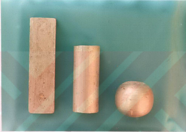
Şekil 5. Isı aktarım katsayılarını belirlemek için kullanılan alüminyum bloklar.
