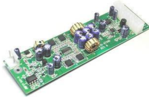
Şekil 4.5 Mini-ITX DC-DC çevirici
