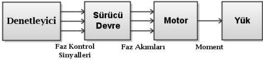
Şekil 4.6 Adım motorlarda açık döngü denetim
