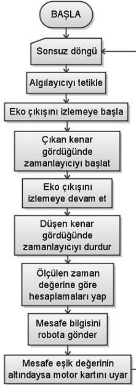
Şekil 4.17 Ultrasonik ölçüm kartındaki mikrodenetleyici programının akış diyagramı
