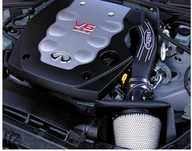
Şekil 2.25 Motor hava emiş sistemi
