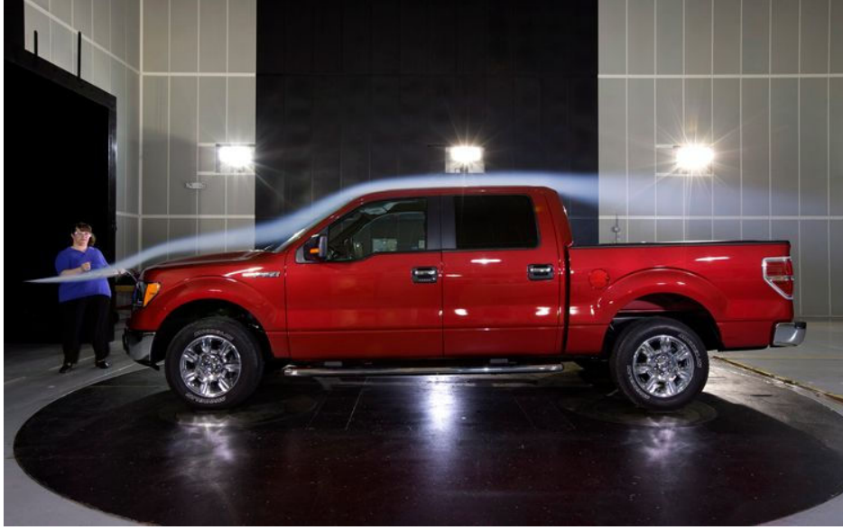
Şekil 2.27 Rüzgar tüneline araç testi
