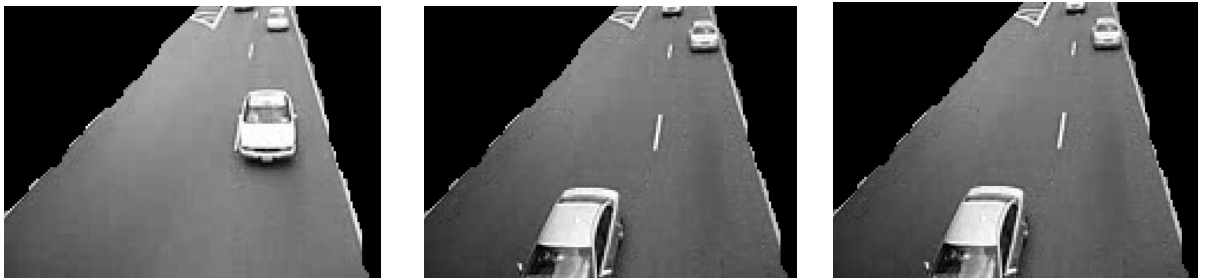
Şekil 3.6 Yol maskelenmesi işlemi yapıldıktan sonraki görüntülerden bazıları.
