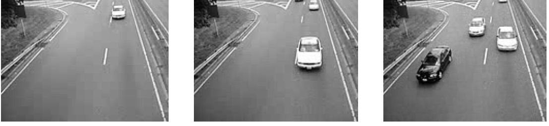
Şekil 3.4 Video görüntüsünün RGB uzayından gri seviyeye dönüştürülmüş hali.
