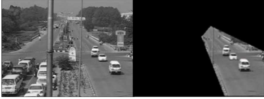
Şekil 3.7 Yol maskelenmesi işleminin kamera görüş açısı otoyolun iki yönünü de alması durumunda istenilen yön için yapılması (Bhatti., 2006).
