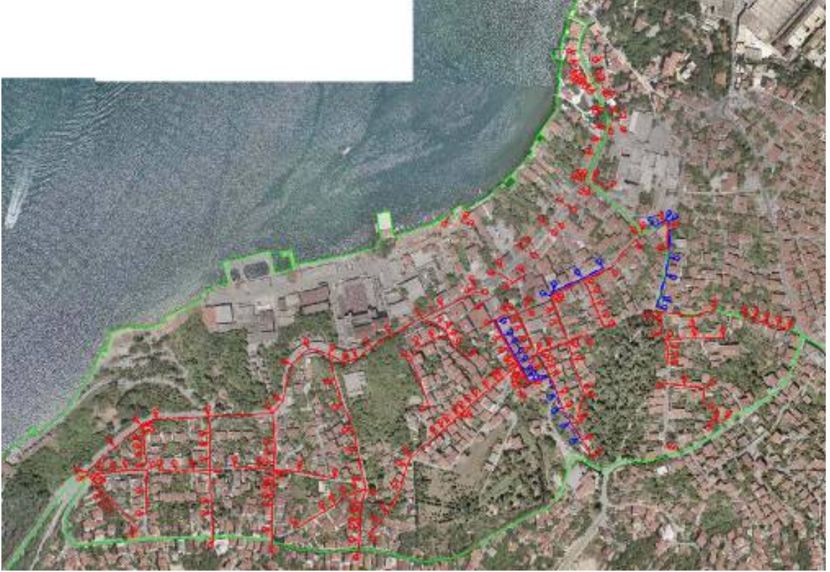
Şekil 4.6 Çalışma alanındaki atıksu hatları
