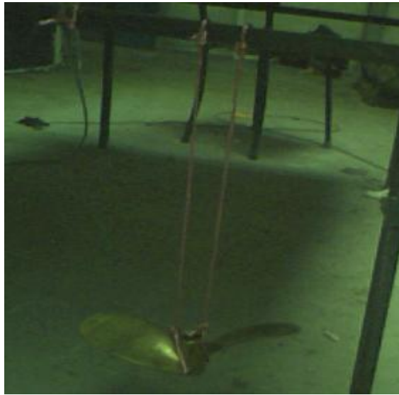
Şekil 3.4 Torsiyonal sarkac ile pervanenin kütle atalet momentinin tespiti
