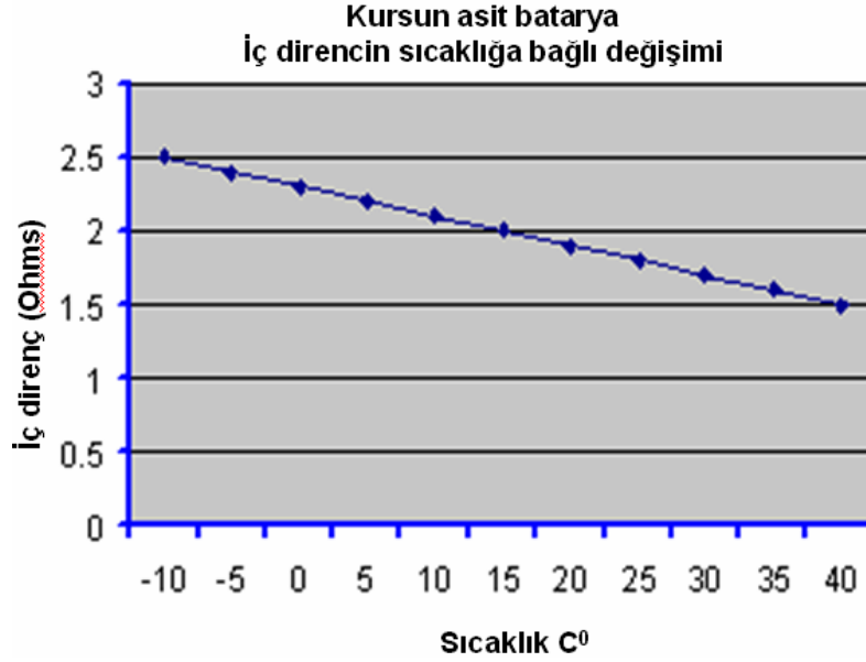
Şekil 3.8 Kurşun asit batarya iç direncinin sıcaklığa bağlı değişimi
