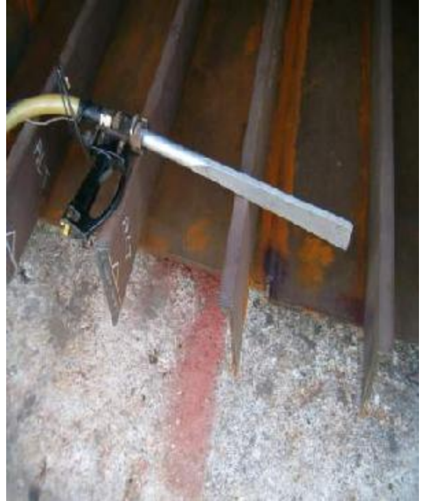
Şekil 6.1 GTF tarafından kuru buz uygulamalarında kullanılan donanım
