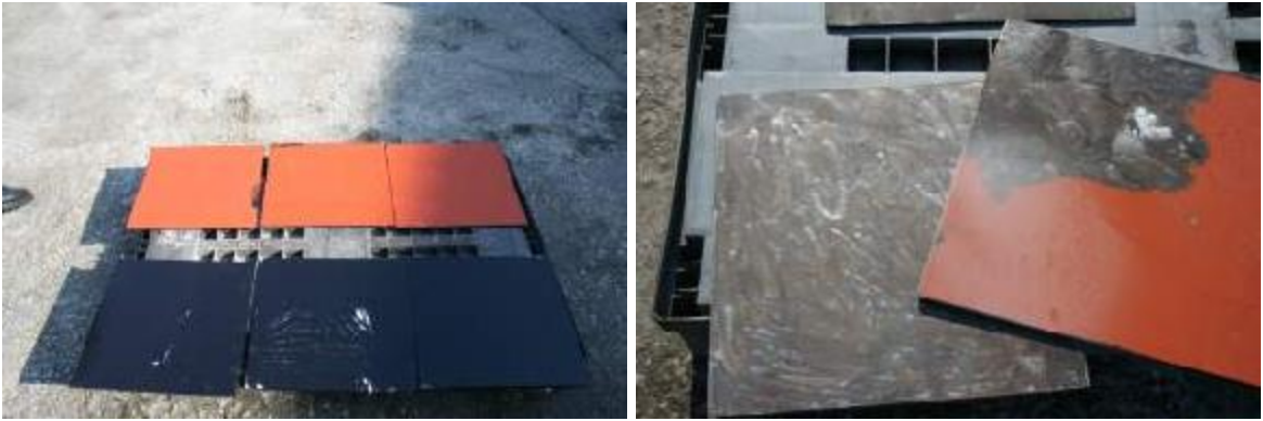
Şekil 6.5 Yüzer Lang kuru buz uygulama numuneleri
