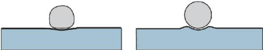
Şekil 4.6 Çelik Bilye sertliğinin doğru seçilmesinin yüzeye etkisi
