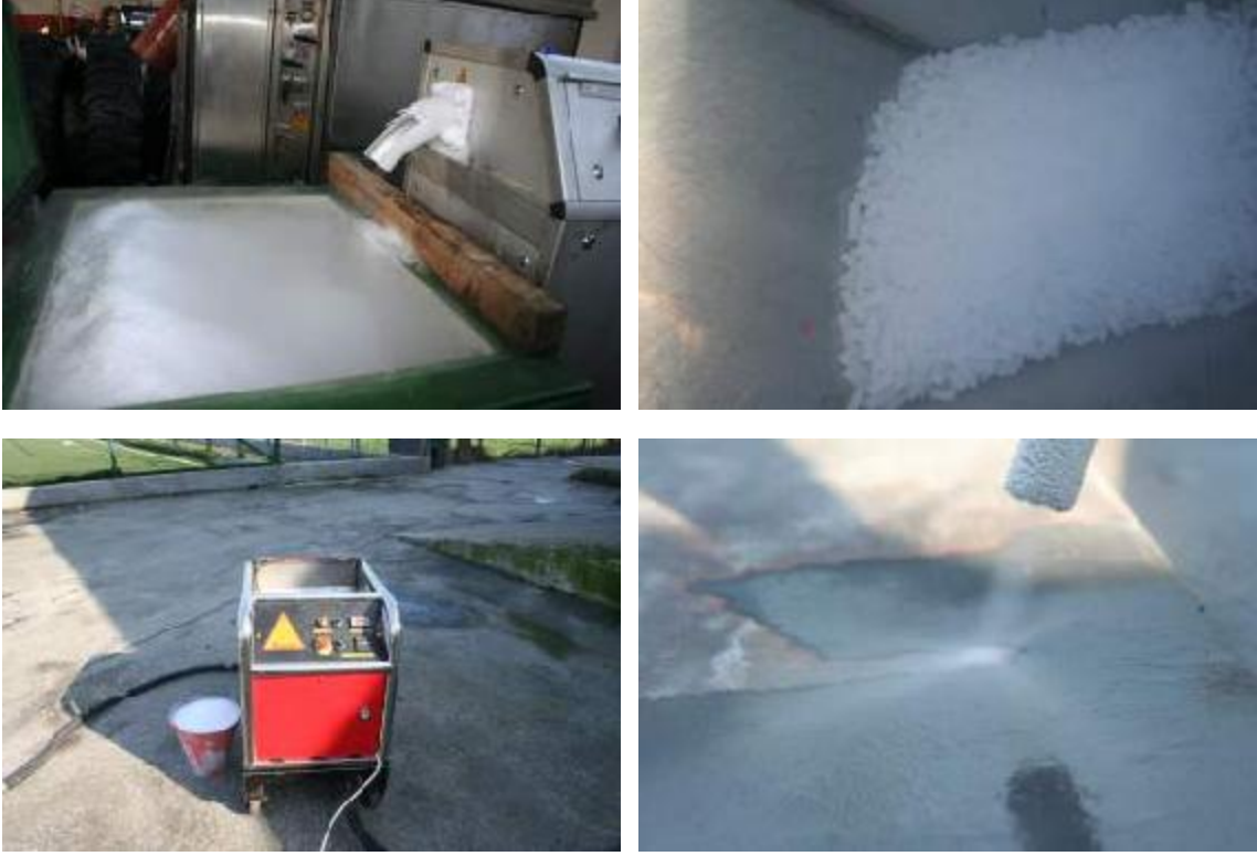
Şekil 6.4 Yüzer Lang tarafından kullanılan kuru buz deney donanımı
