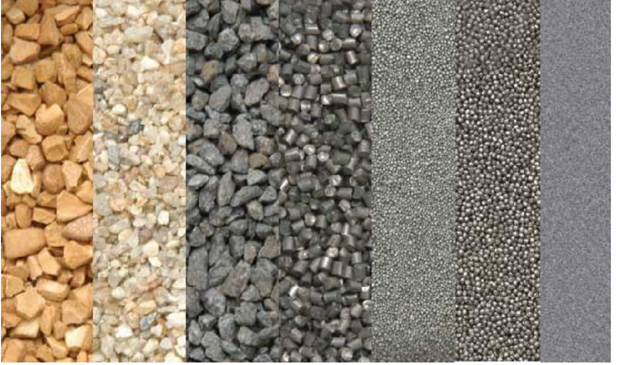
Şekil 4.2 Kullanılan değişik aşındırıcı raspa malzemeleri
