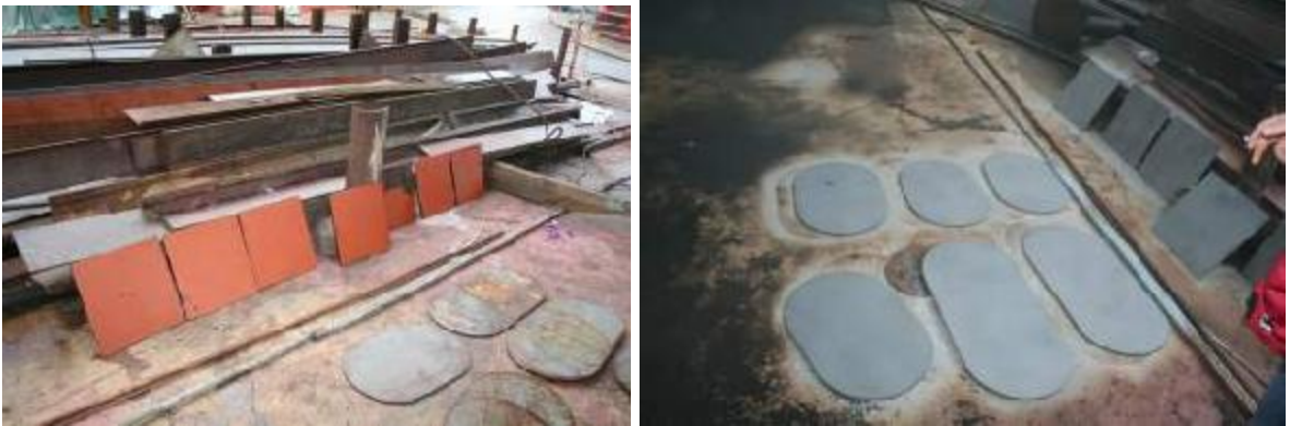
Şekil 6.6 İstanbul Tersanesi grit raspa uygulama numuneleri ve atık durumu
