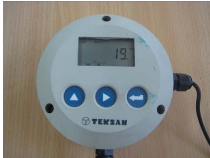
Şekil 3.4 Kanaldaki akımın ve su jetinin debisinin belirlenmesinde kullanılan debimetre
