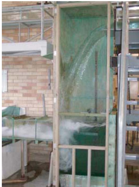
Şekil 2.19 Şaft içinde serbest düşü yapan su jeti (Chanson, 2007)
