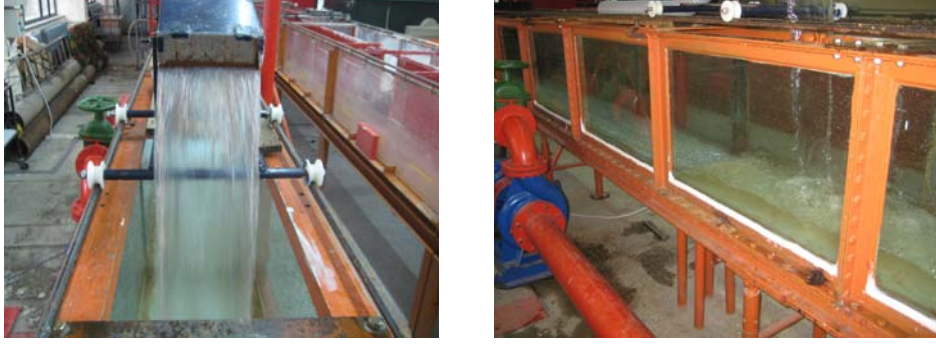
Şekil 4.2 Kanal akımına verilen jet mekanizması ve çarpan su jeti
