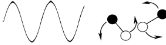
Şekil 7.3 Elektrik alanla uyumlaşmaya çalışan dipolar moleküller [43]
