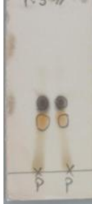
Şekil 9.9 KMnO 4 ile 1-benzil-4,5,6,7-tetrahidro-6,6-dimetil-4-okso-1 H -indol-7-il asetat sentezinin İTK sonucu
