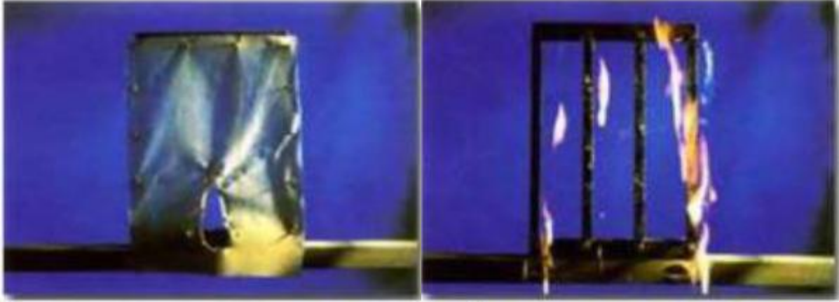
Őekil 5.7 Alev geciktirici katkı ve katkısız polietilen film yanma testi [86]
