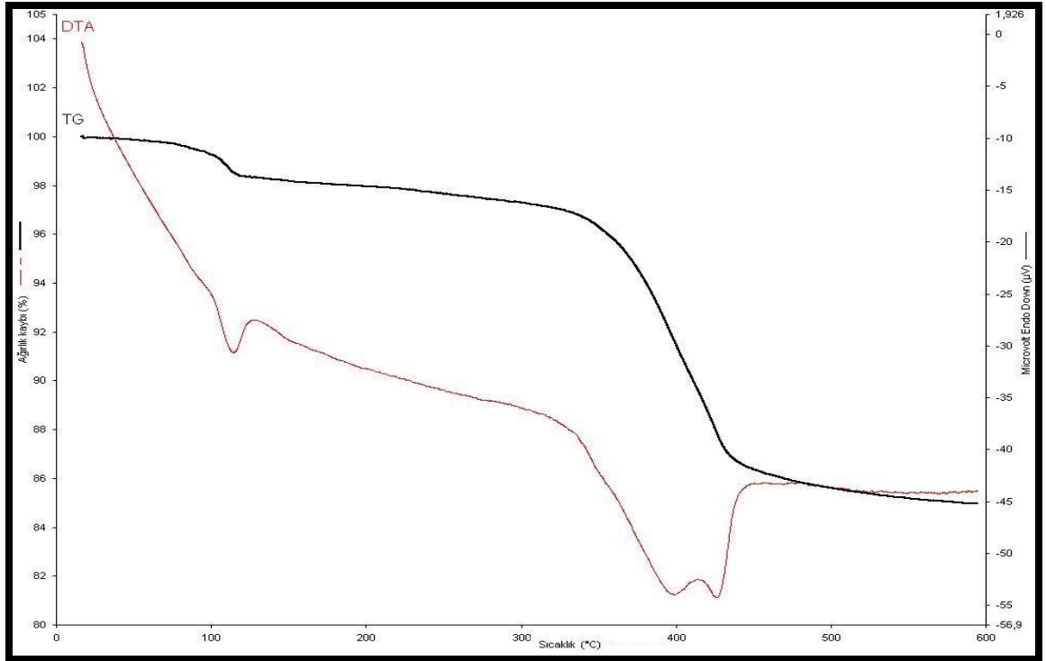
Şekil 8.101 Mekanik karıştırırmalı sistemde optimum koşullar için sentezlenen Çinko Boratın TG/DTA eğrisi (2 saat, 4:1, % 0.5 aşı, 500 rpm, 95°C)
