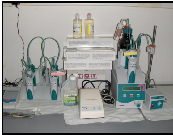
Şekil 7.4 Potansiyometrik titrasyon cihazı
