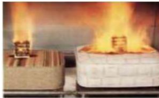
Şekil 5.4 Alev geciktirici katkılı ve katkısız yatak yanma testi [86]
