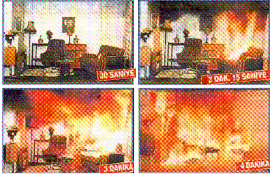
Şekil 3.3 Yangının büyüme hızı deneyi [33]
