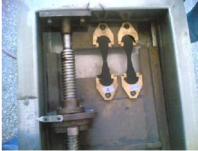
Şekil 3.4 Düktilite cihazı mekanizması [28]
