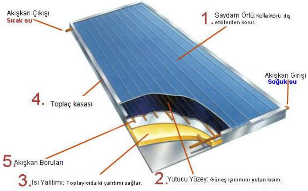
Şekil 3.6 Düz toplacın temel elemanları [12]
