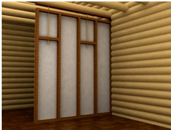
Şekil 4. 28 Üstteki lata ile çerçevenin kavelalar ile birbirine bağlanması [41]
