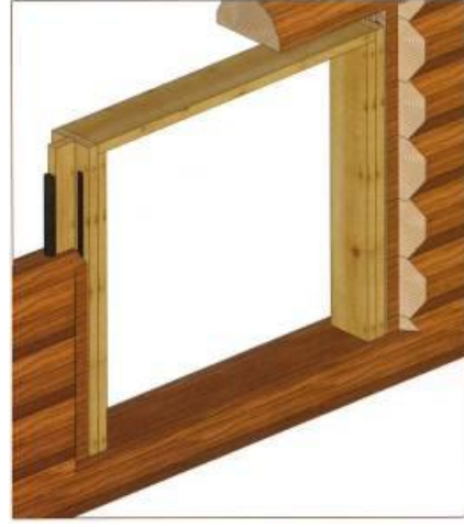
Şekil 3. 71-b Yanlarda çift parça kullanılan, üç kenardan oluşan tam çerçeve [192]
