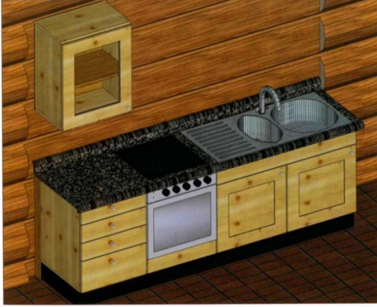
Şekil 3. 104-a Düzleştirilmiş kütük duvarda mutfak dolabı [192]
