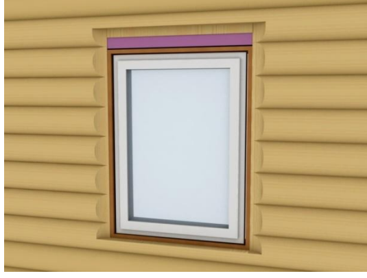
Şekil 4. 55 Pencere kasasının kör kasaya oturtulması [41]
