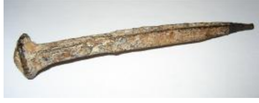
Şekil 2. 9 Geleneksel çantı yapılarında kullanılan el yapımı dövme demir çivi [41]
