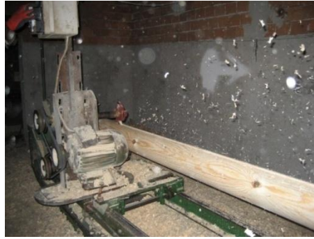
Şekil 4. 2-b Kütüklerde lamba zıvana geçmelerin açılması [41]
