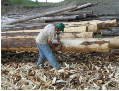
Şekil 2. 12 Geleneksel yöntemde kabukların soyulması ve boyuna kanal açılması [47]
