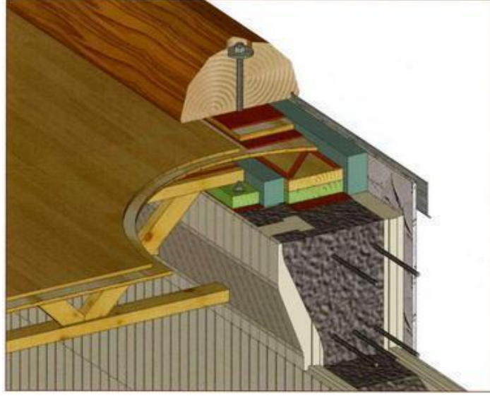
Şekil 3. 140 Makaslardan oluşan zemin kat döşemesinin duvar bağlantısı [192]
