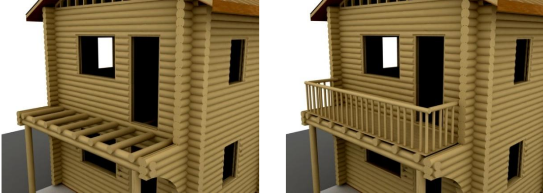
Şekil 4. 37 Dışa doğru uzatılan balkon döşeme kirişleri ve bunların üzerine rabitaların çakılıp korkuluğun monte edilmesi [41]
