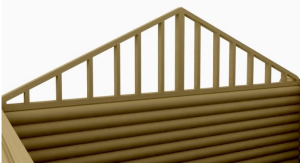
Şekil 4. 40-a Kalkan duvarın kütük duvara oturtulması [41]
