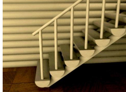
Şekil 4.38-b Küpeşte ve korkulukların montajı [41]
