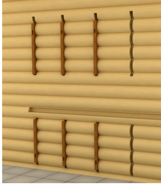
Şekil 4. 61 Kütük duvar üzerinde açılan kanallara askı çıtalarının tespit edilmesi [41]
