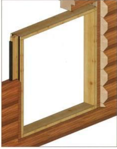
Şekil 3. 71-a Dört kenardan oluşan tam çerçeve [192]
