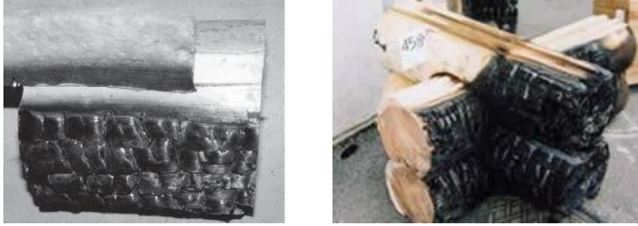
Şekil 2. 46 Ahşap yüzeyinde oluşan kömür tabakası ve yanmış bir köşe geçmesi [106], [89]
