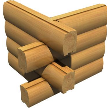
Şekil 2. 31 Geçme – binmeli köşe birleşimi [55]
