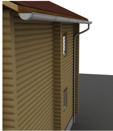
Şekil 4. 45 Çatıya monte edilen oluk ve yağmur iniş borusu [41]
