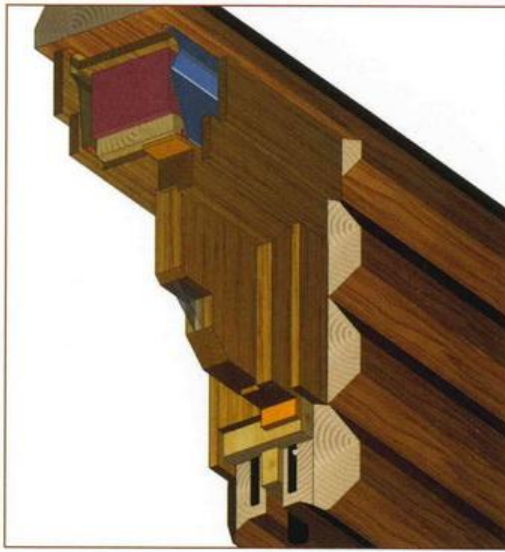
Şekil 3. 85-a Kapının çerçeveye monte edilmesi [192]
