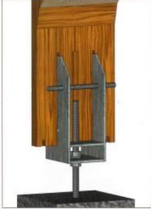
Şekil 3. 59-a Çubuğun temele gömülü olduğu ayar vidası [192]
