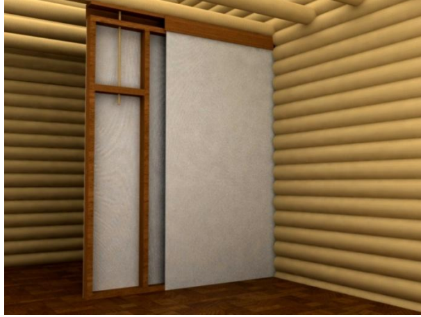
Şekil 4. 29 Çerçeve duvarın her iki taraftan alçı levha ile kaplanıp oturma payı pervazlarının lataya tespit edilmesi [41]
