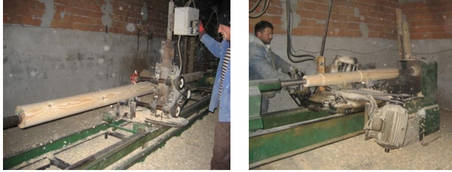
Şekil 4. 2-a Kütüklerin ikinci torna makinesinde istenen çapa getirilmesi [41]
