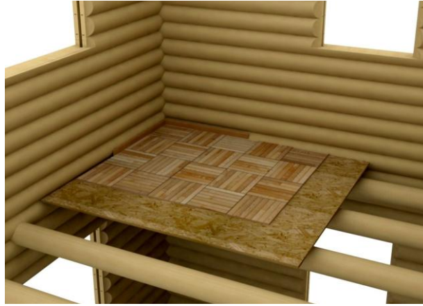
Şekil 4. 36 Isı yalıtımsız, normal kat döşemesi [41]
