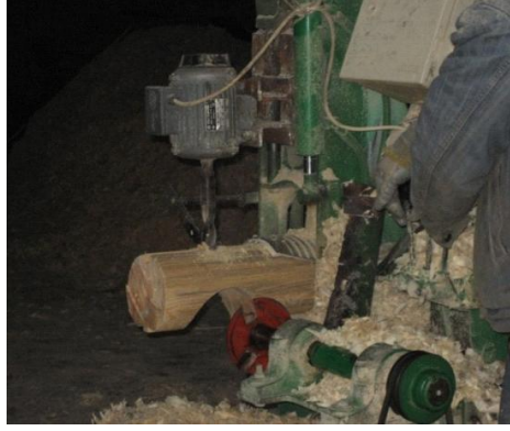
Şekil 4. 3 Karaboğaz geçme yapılacak kütüklerin altından parça çıkartılması [41]
