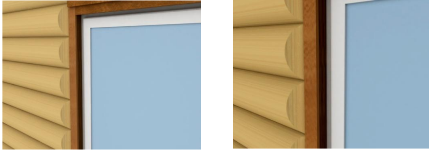
Şekil 4. 58 Pencerenin iç tarafına, kasayla pervaz arasına yan pervazın tespit edilmesi [41]
