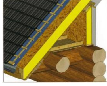
Şekil 3. 204 Yapısal yalıtımlı panel ve bununla oluşturulmuş panel çatı [289], [192]
