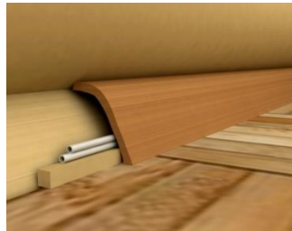
Şekil 4. 50 Süpürgelik ile duvar arasından geçirilen kablolar [41]
