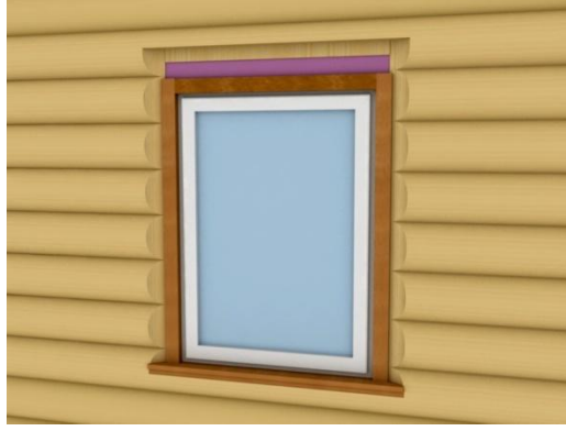
Şekil 4. 57 Pervazların çerçeveye tespit edilmesi [41]
