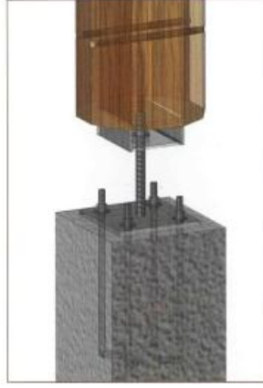
Şekil 3. 59-b Çubuğun metal plakaya kaynaklandığı ayar vidası [192]
