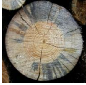
Şekil 2. 52 Mavi leke oluşan bir kütük kesiti [118]
