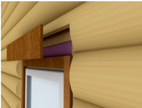
Şekil 4. 59 Oturma payı pervazının çıtaya tespit edilmesi [41]
