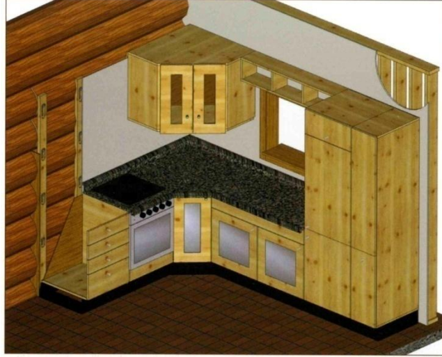
Şekil 3. 108 Mutfak dolaplarının, kütük duvar üzerindeki çerçeveye sabitlenmesi [192]
