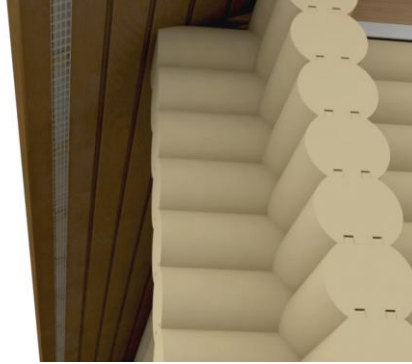
Şekil 4. 44 Mertek uçlarında bırakılan hava girişi [41]
