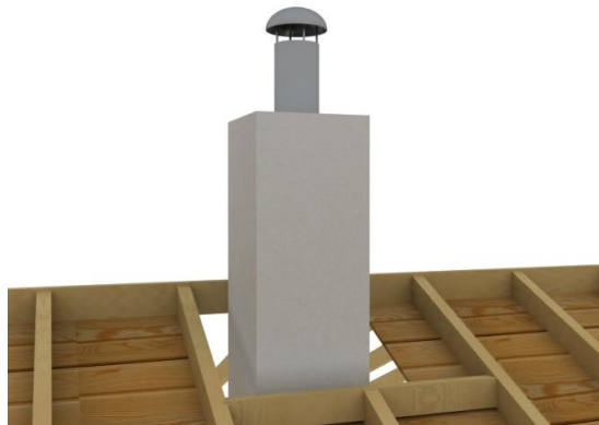
Şekil 4. 47 Çatının üzerine doğru uzanan baca ve mertekler ile baca duvarı arasında bırakılan boşluk [41]
