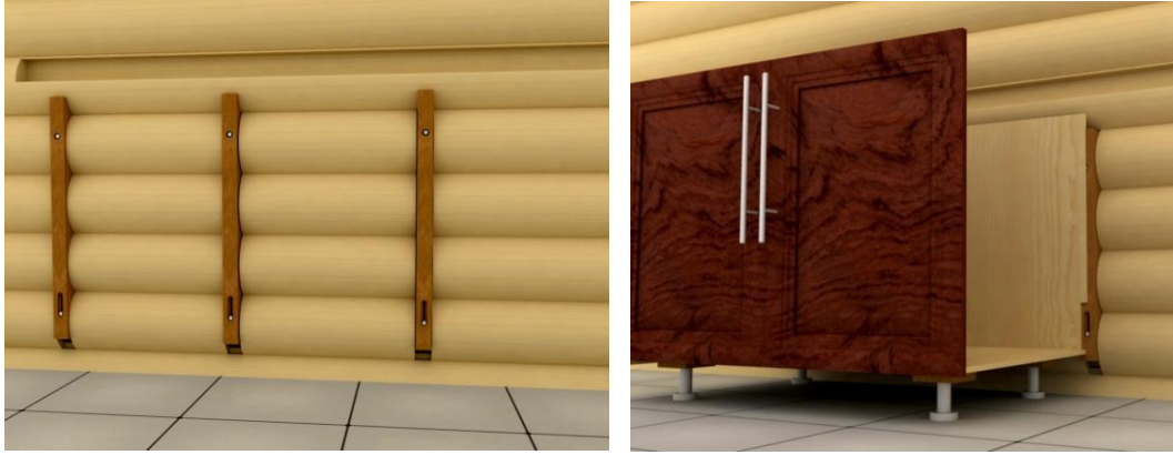
Şekil 4. 62 Alt dolaplar için askı çıtaları ve dolapların bunlara montajı [41]
