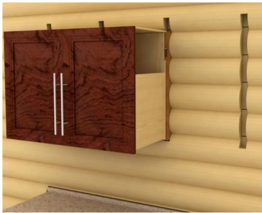
Şekil 4. 65 Üst dolapların, askı çıtalarına montajı [41]
