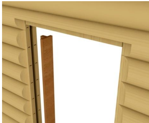
Şekil 4. 52 Kütüklerin ucundaki kanala geçirilen çita ve çerçeve parçası [41]
