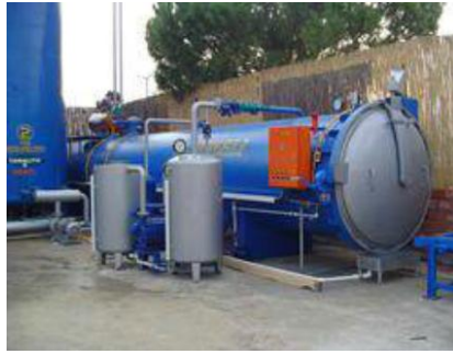
Şekil 3. 26 Empenye kazanı ve kütüklerin kazana yerleştirilmesi [179], [92]
