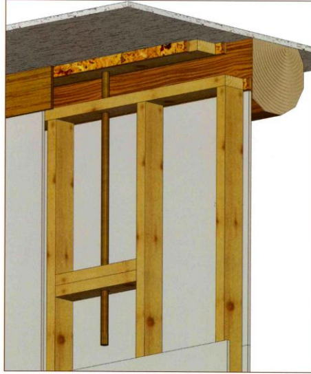
Şekil 3. 97 Kütük kirişin yanına yerleştirilen çerçeve duvar [192]
