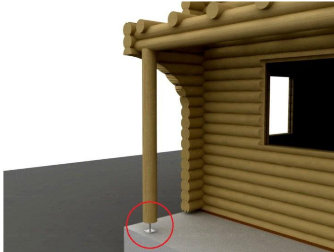
Şekil 4. 30 Dikme ve altına yerleştirilen ayar vidası [41]
