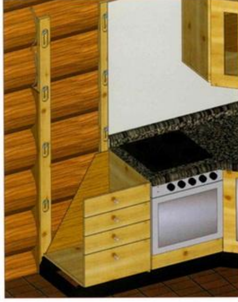
Şekil 3. 109 Kütük duvara sabitlenen çerçeve dikmeleri ve mutfak dolapları [192]
