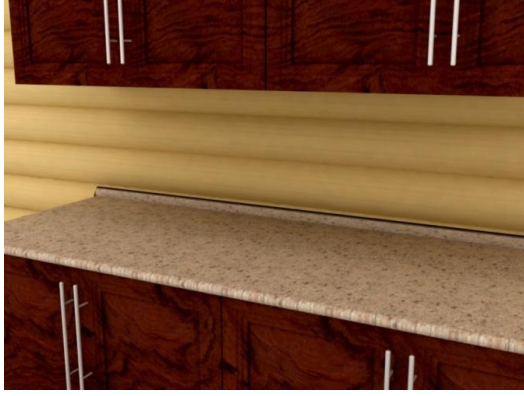
Şekil 4. 63 Tezgâhın kütükte açılan kanala yerleştirilmesi [41]
