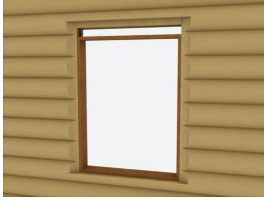
Şekil 4. 53 Çerçeve üst parçasının yan parçalara tespit edilmesi [41]
