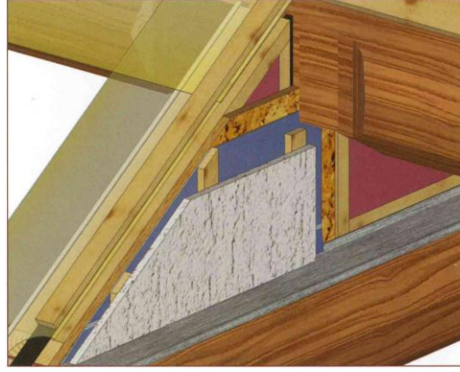
Şekil 3. 217 Kütük duvar üzerinde çerçeve kalkan duvar detayı [212]
