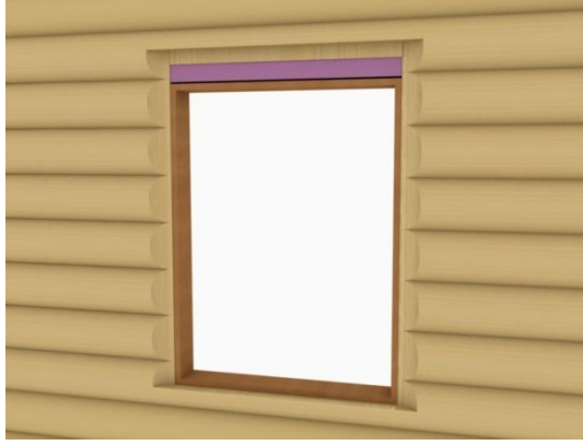
Şekil 4. 54 Başlık kütüğünün altına ısı yalıtım köpüğünün yerleştirilmesi [41]
