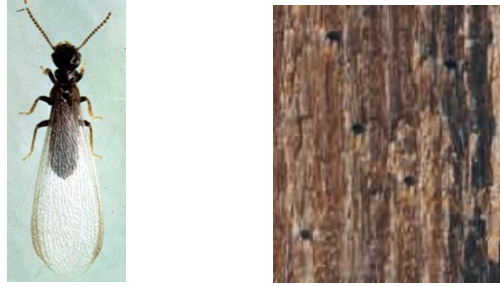
Şekil 2. 59 Termit ergini ve termit delikleri [121], [99]
