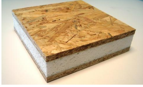
Şekil 3. 204 Yapısal yalıtımlı panel ve bununla oluşturulmuş panel çatı [289], [192]
