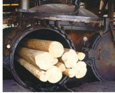
Şekil 3. 26 Empenye kazanı ve kütüklerin kazana yerleştirilmesi [179], [92]
