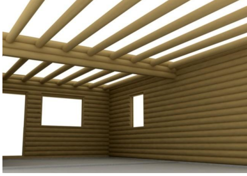
Şekil 4.32 Döşeme kirişlerinin ana kütük kirişlerle birleşimi [41]
