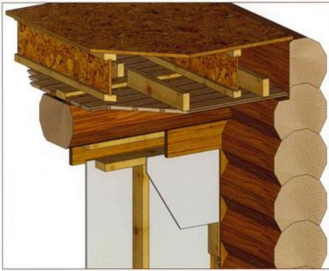
Şekil 3. 94 Kütük kirişin altına, ona paralel olarak yerleştirilen çerçeve duvar [192]
