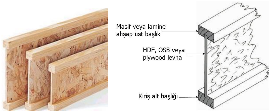
Şekil 3. 144 Döşeme kirişi olarak kullanılan I kirişler [247], [246]
