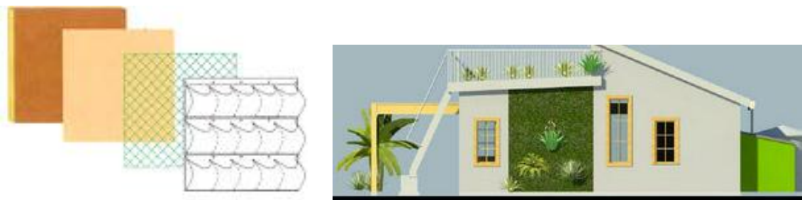
Şekil 3. 53 Yeşil duvar katmanları ve yeşil duvar görünümü [109]
