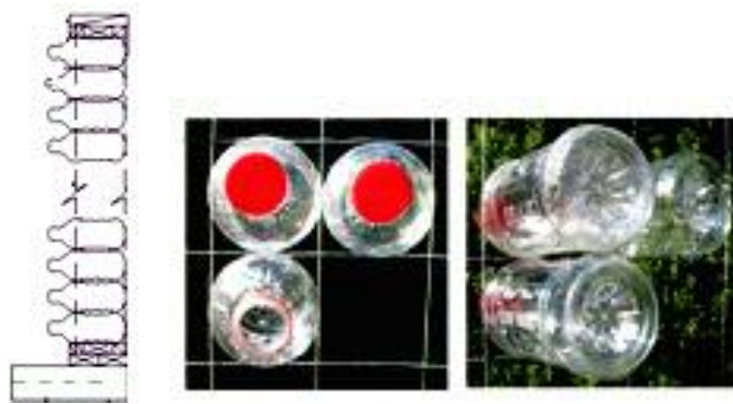
Şekil 3. 52 Plastik şişelerden dış duvar elemanlarının oluşturulması [109]
