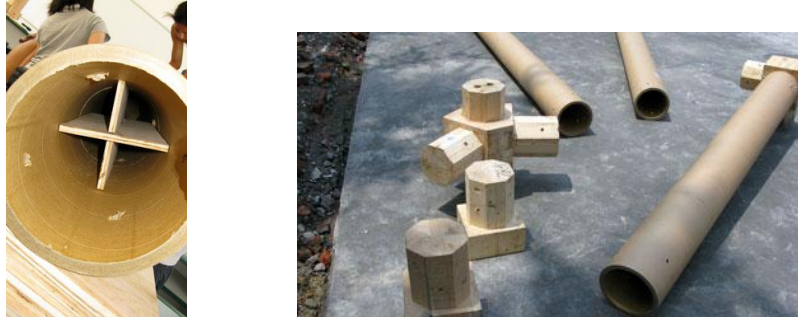
Şekil 3. 26 Geçici eğitim birimlerine ait kağıt tüp kolon ve kiriş elemanları ve bağlantı elemanları [88]
