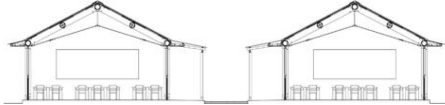
Şekil 3. 21 Kağıt tüp geçici eğitim yapılarına ait kesit [90]
