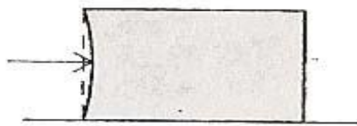
Şekil 3.22 Yapılarda pozitif basınç etkisi [43]
