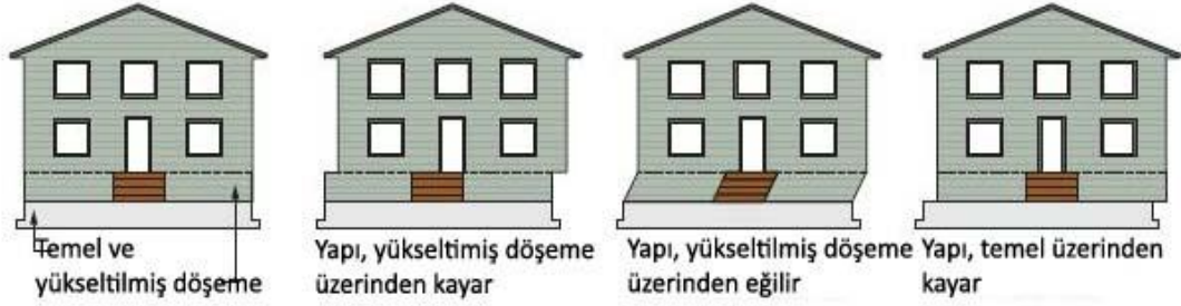
Şekil 4.7 Yükseltilmiş döşemede görülen kayma etkisi [53]
