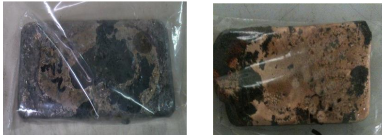
Şekil 7.2 2.1 ve 2.2 Numune no'lu ergitme işlemleri sonucu elde edilen metalik fazlar
