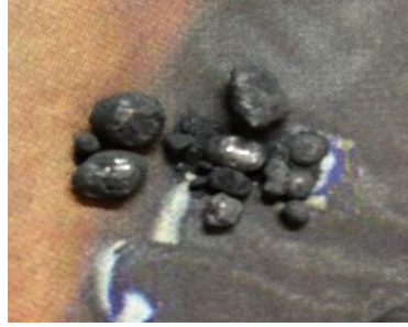
Şekil 7.4 Curuf içerisinde tespit edilen metalik granül şeklindeki parçalar
