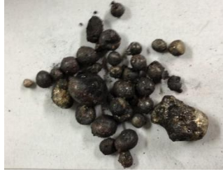
Őekil 7.9 4.tip curuflařtırıcı ile yapılan ergitme sonucu cruf ierisindeki metalik granl fazlar
