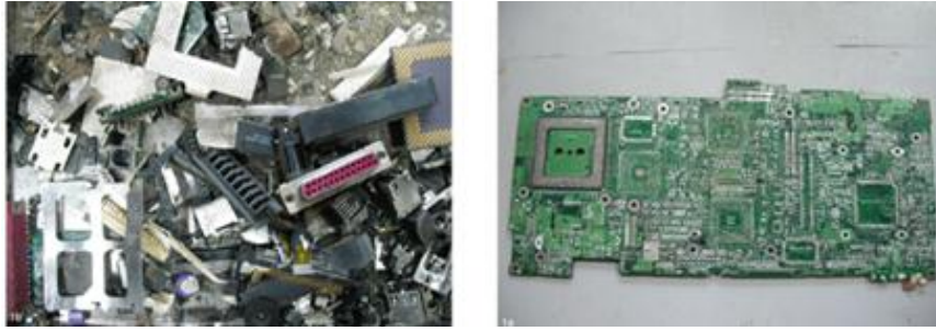
Şekil 4.2 Demontaj işlemi sonrası PCB üzerinden çıkartılan parçalar ve nihai atık ürün
