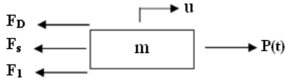
Şekil 2. 2 Tek serbestlik dereceli sistemin serbest cisim diyagramı
