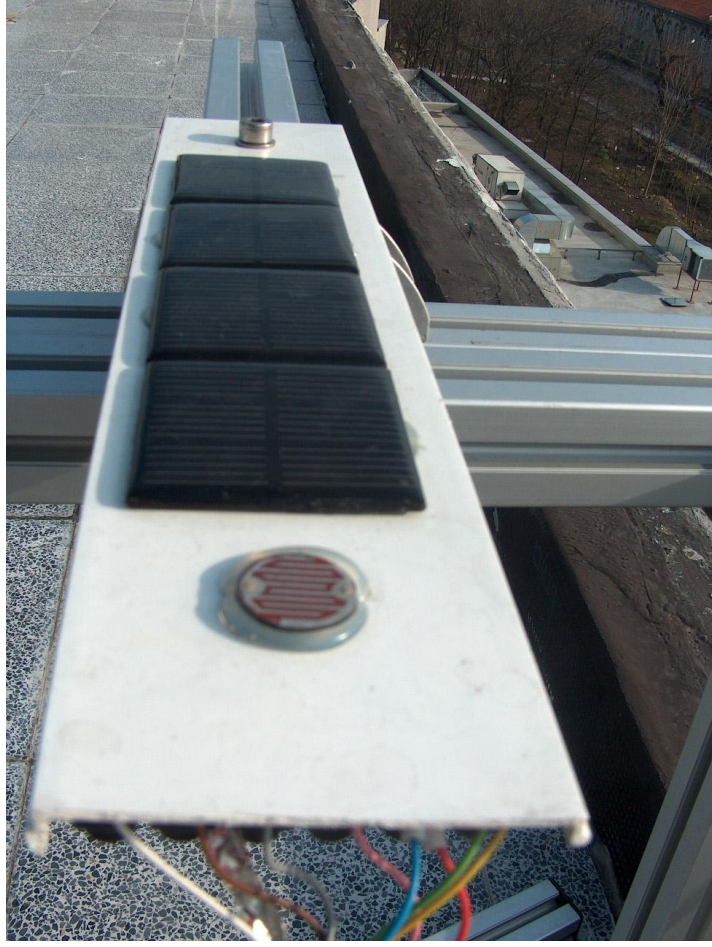
Şekil 4. 8 Mini PV modüller ve LDR' den oluşan ışınım ölçüm düzeneği
