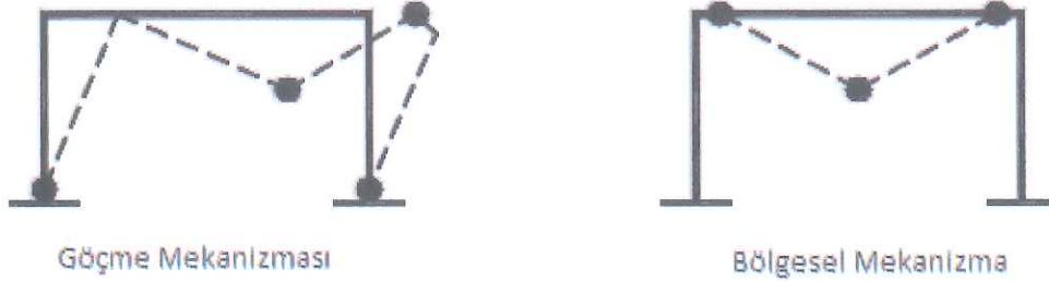
Şekil 4.6 Göçme ve bölgesel mekanizma durumları [36]
