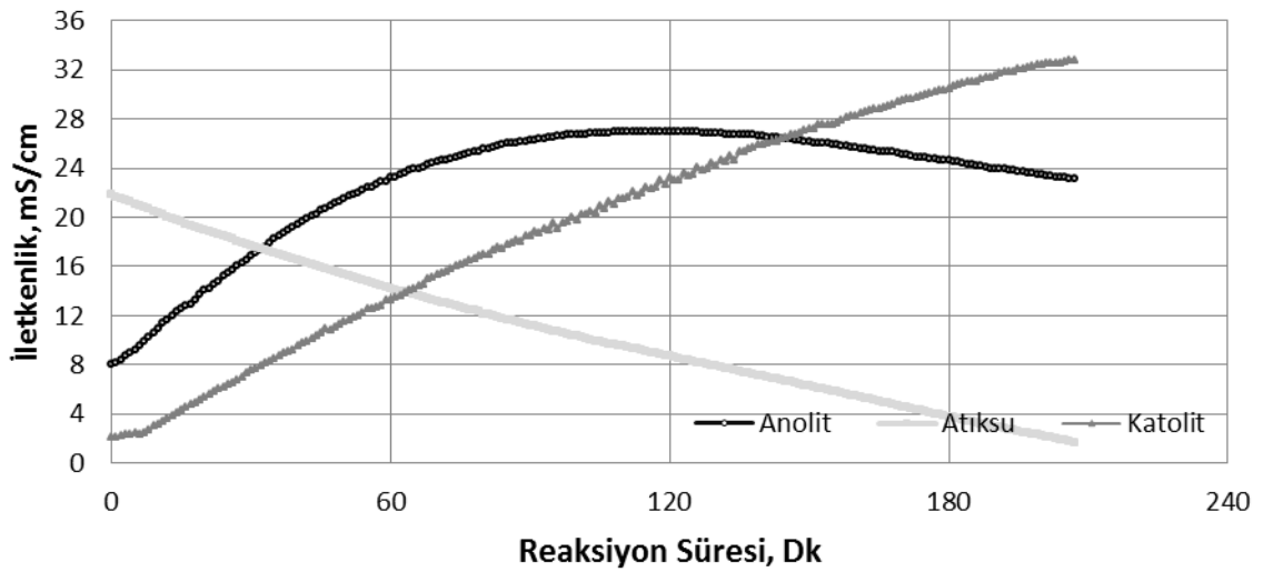
Şekil 5.55 Genç sızıntı suyundan elektrodiyaliz prosesiyle diluat, anolit ve katolitte iletkenlik değişimi
