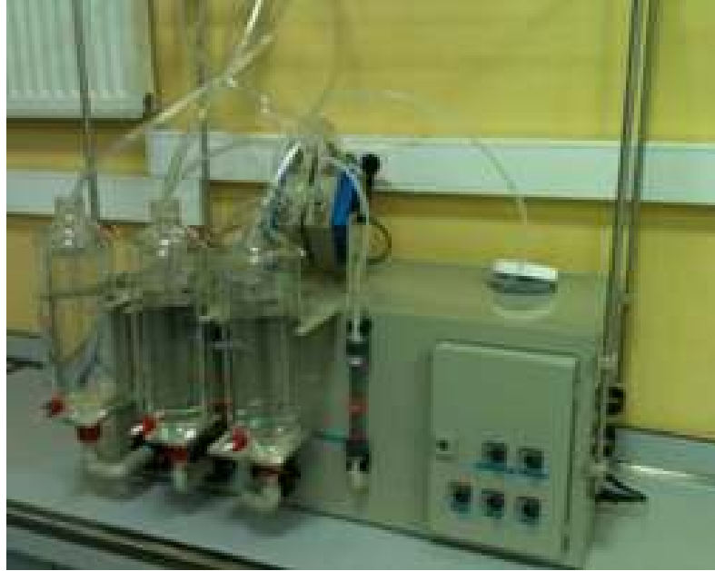
Şekil 4.5 Elektrodiyaliz bipolar membran reaktör
